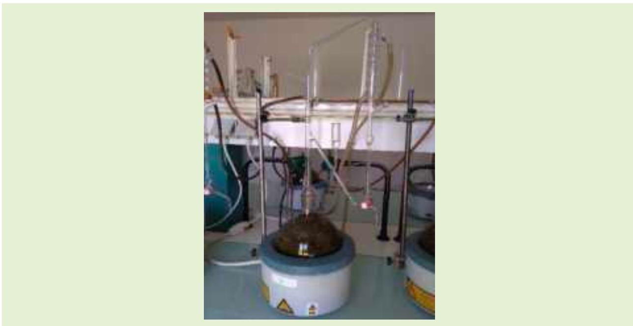
*Figure 2 : Montage d'hydrodistillation de type Clevenger, CRIEPPAM.*
