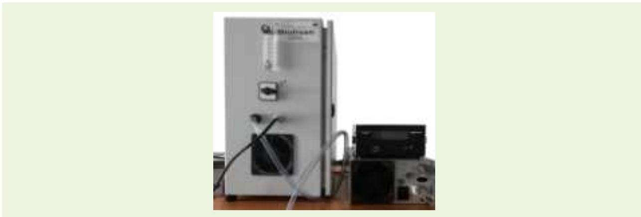
Figure 33 : Générateur d'ozono Biofresh LM-5 (sx) et sonde de mesure d'ozone Analyzer uv-100 (dx).
