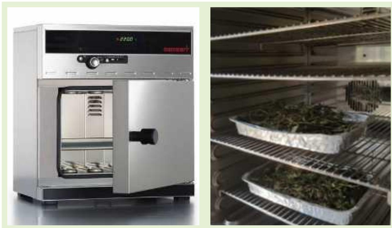
*Figure 7 : Séchoir à air forcé utilisé en Italie, DISAFA.*
