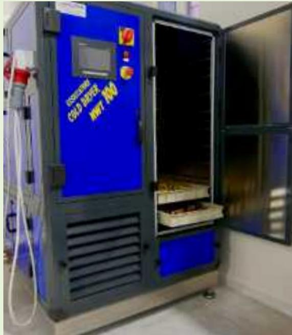
Figure 48 : Déshumidificateur de marque Northwest Technologies, Le Terre dei Savoia.
