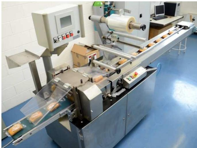
**Fig. 6. Confezionatrice Flow Pack orizzontale modello HS-E160 della F.D.M.**
