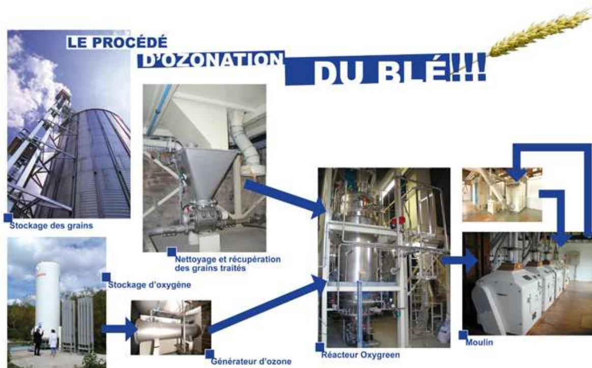
Il processo utilizza un reattore verticale agitato, i grani sono spazzati da una corrente d'aria ozonizzata. Questo processo consente di ottenere cereali molto ben decontaminati per la produzione di farine ad alta qualità microbiologica.
