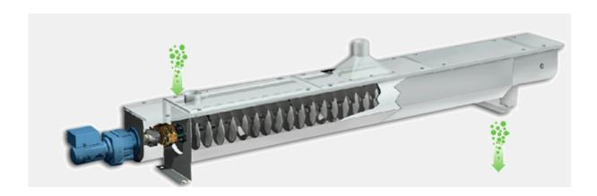
La vis de transport est en acier inoxydable donc résistif - Elle est parcourue par un courant basse tension mais de forte intensité générant un échauffement de la vis par effet Joule Le produit circule par entraînement mécanique de la vis mise en rotation Il est chauffé par conduction/convection par la vis chaude
