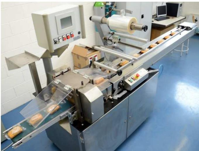
Fig. 6. Emballeuse Flow Pack horizontale modèle HS-E160 de F.D.M.
