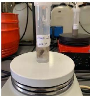
**Figure 4. Peau broyée en solution de NaOH 0.1 M sur agitateur magnétique chauffant modèle AREX F20500413 (ww.velp.com).**
