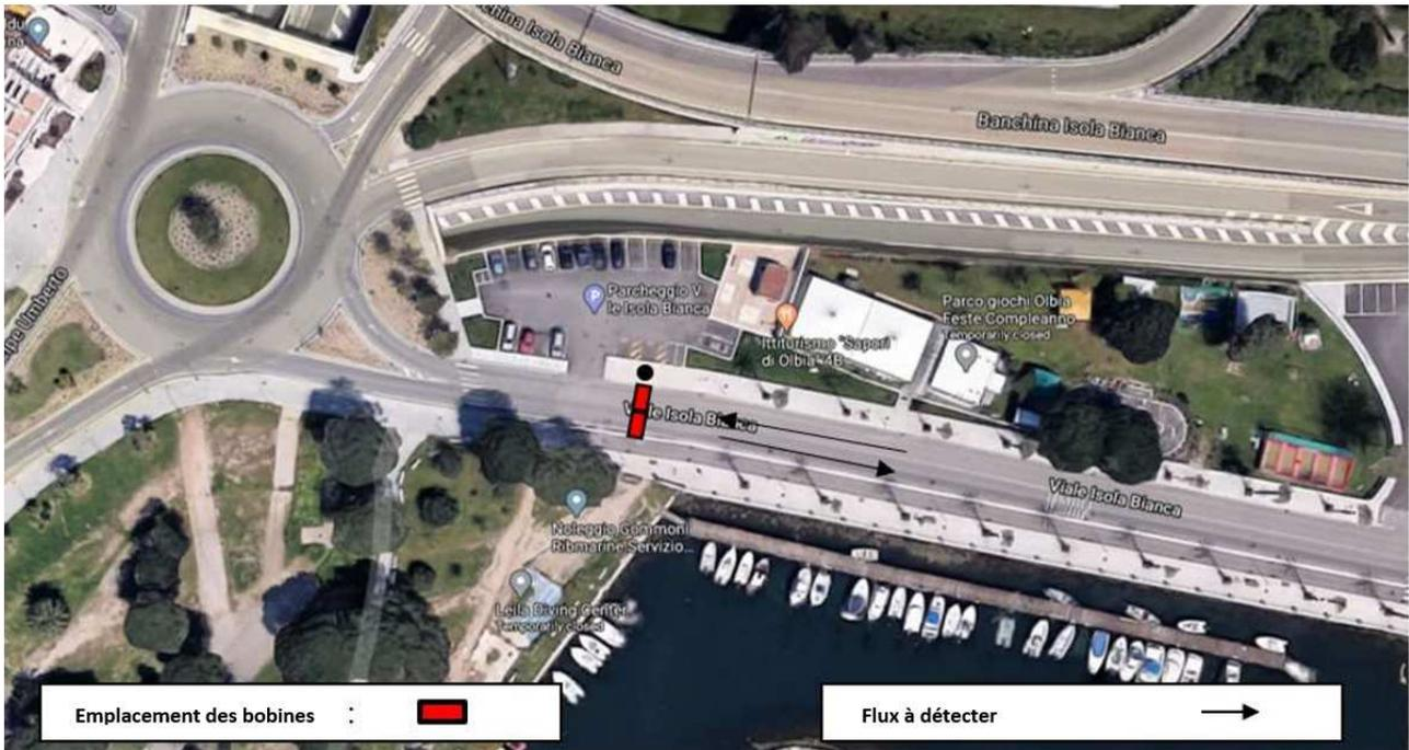
Figure 15 - Détecteur de trafic n ° 2 dans Viale Isola Bianca
