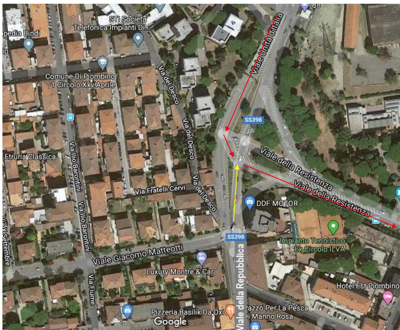
Fig. 6. Intersection entre Viale Unità d'Italia et Viale della Resistenza. L'itinéraire des véhicules allant au port est indiqué en rouge, et celui des véhicules venant du centre de Piombino est indiqué en jaune.
