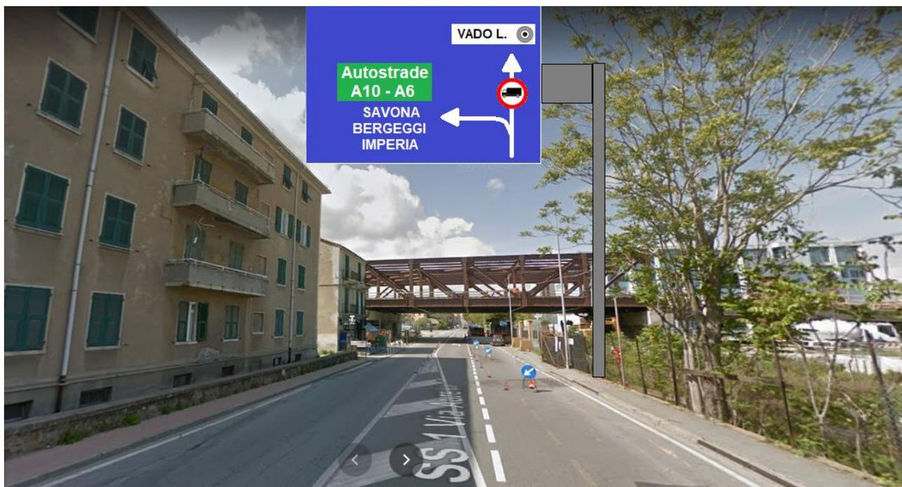
Fig. 9. Exemple d'un panneau fixe qui doit être placé à l'intersection entre la Vieille Aurelia et via Trieste, pour empêcher les véhicules se dirigeant vers l'autoroute de «prendre la mauvaise route» et de continuer tout droit à travers le centre de Vado Ligure. Le code de la route précise que: le support vertical du panneau doit être placé à 50 cm du bord du trottoir, tandis que le panneau lui-même doit être placé à une hauteur d'au moins 5,1 mètres du niveau de la route.
