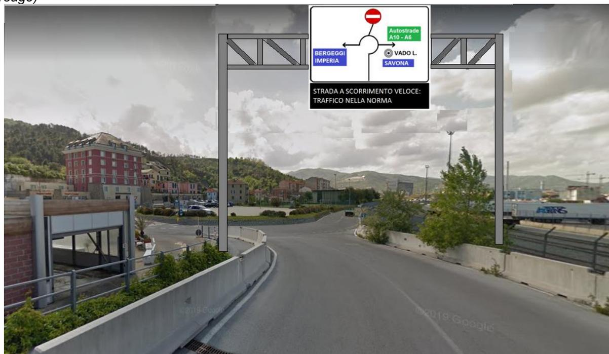
Fig. 6b. Position du PMV1 indiquée sur «Street View». Pour le PMV1, un support «portail» est présenté à titre d'exemple. Le code de la route précise que le PMV doit être positionné: à une hauteur de 5,1 m de la chaussée; tandis que les supports verticaux (c'est-à-dire les pylônes) du «portail» sur lequel est placé le PMV doivent être placés à au moins 0,50 m du bord extérieur du quai.
