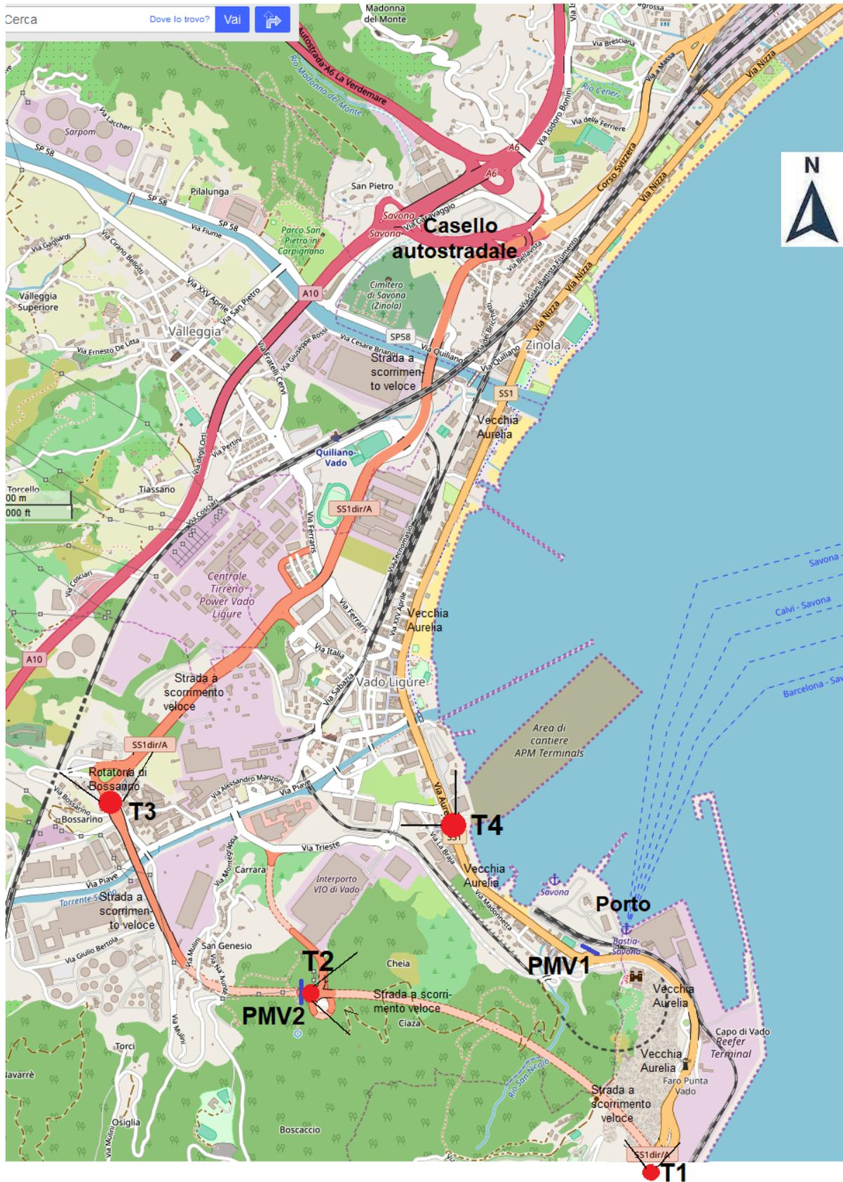
Fig. 4 . Position des PMV 1 et 2 et des 4 caméras. Les PMV sont indiqués en bleu et les caméras en rouge.
