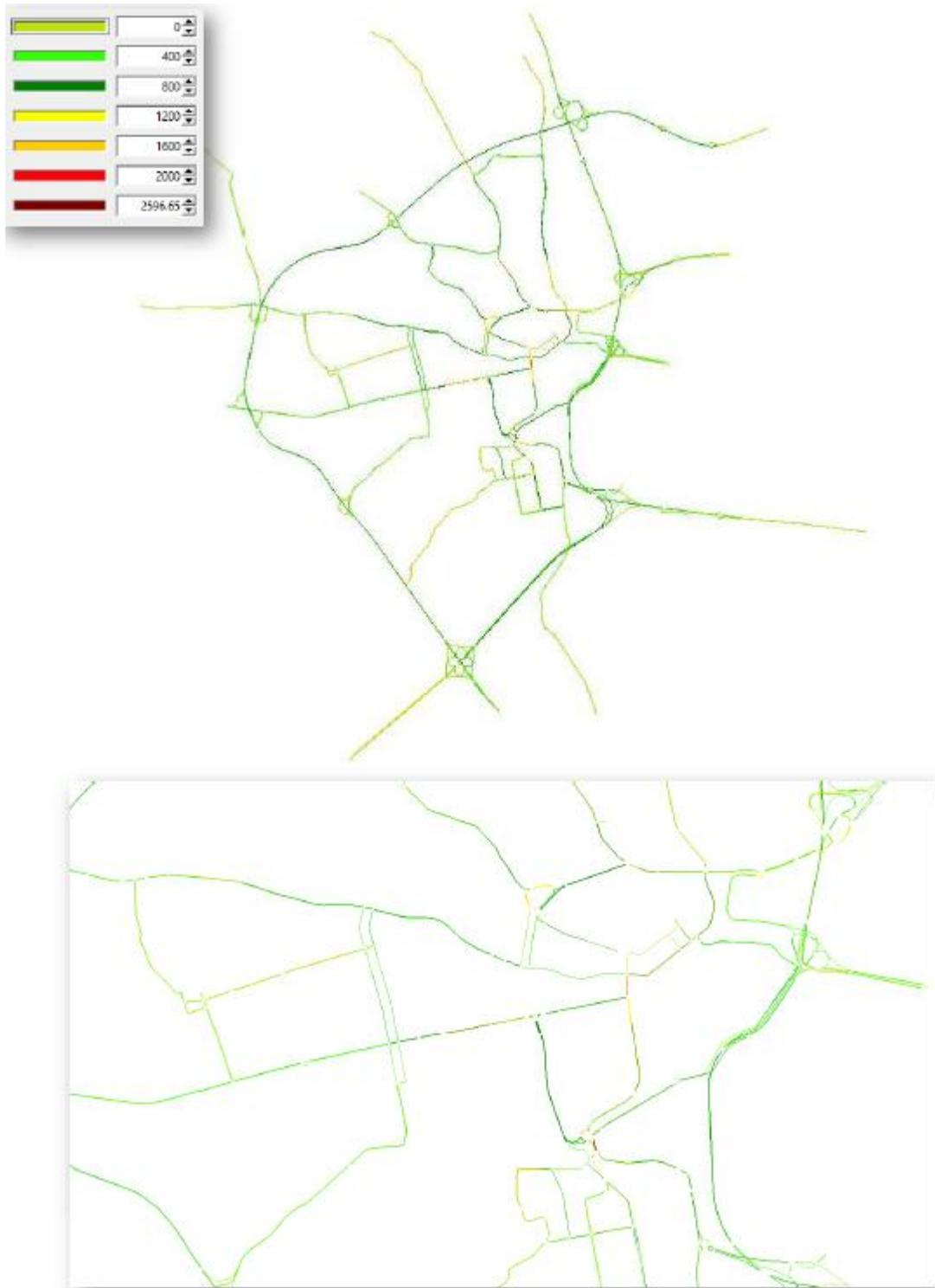
Figure 4.3: Distribution des flux de trafic (véhicules/h) à l'heure de pointe du matin d'automne (avec zoom sur le centre d'Olbia)
