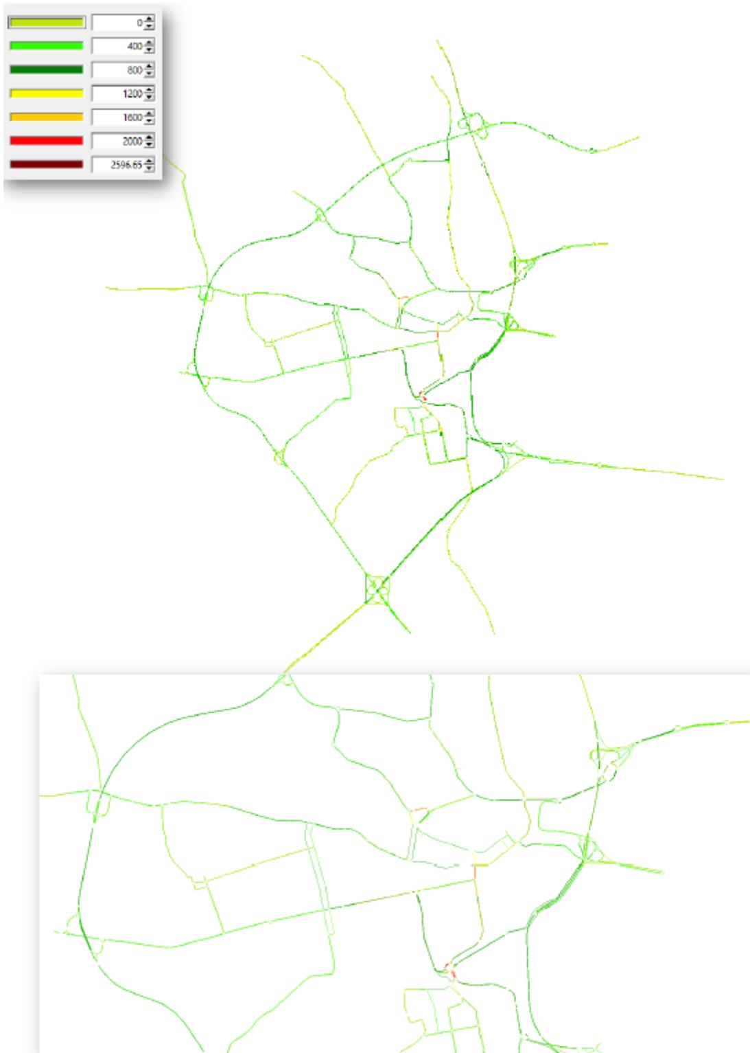
Figure 4.4: Distribution des flux de circulation (véhicules/h) à l'heure de pointe de l'après-midi d'automne (avec zoom sur le centre ville d'Olbia)
