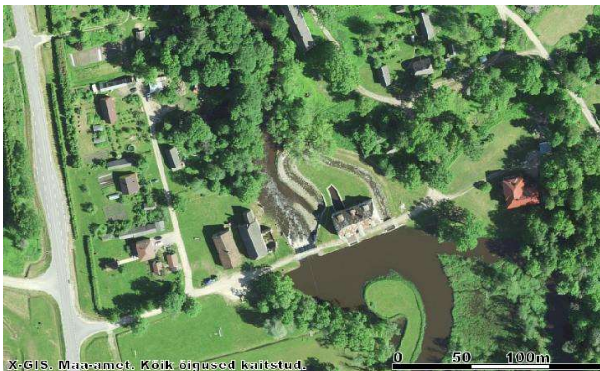
Joonis 2. Vastse-Roosa pais ortofotol. Vasakul laiema harul asub liigveelask, keskel HEJ hoone kohal turbiinikanali sisse- ja väljavool (väljavoolukanal jätkub pärast ca 15 m maa-aluse toruna kuni jõeni) ning paremal kitsama haruna on kalapääs, mis suubub jõkke parkümmend m allpool liigveelasku.
