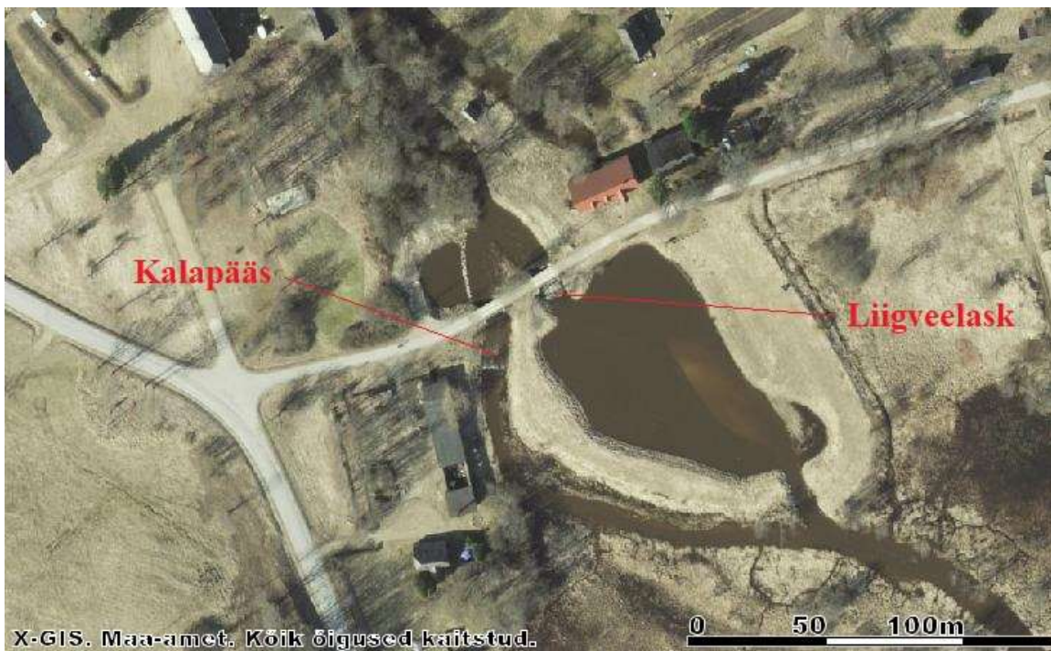
Joonis 2. Sanna Alaveski paisu kalapääs asub jõe vasakul harul, liigveelask paremal harul.
