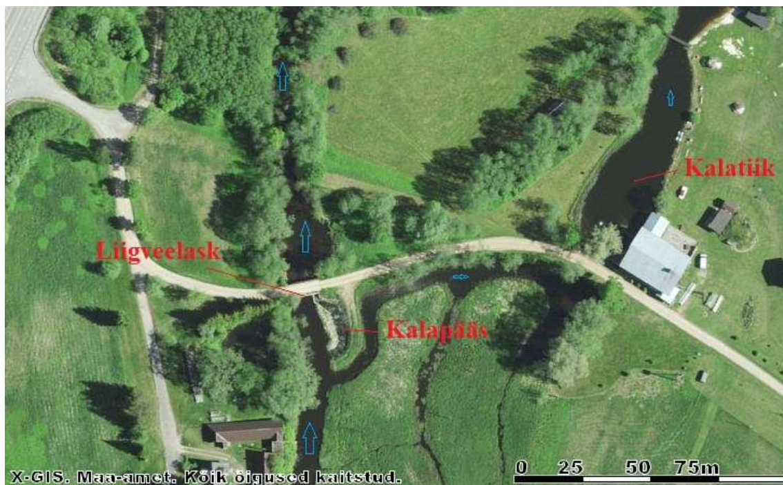
Joonis 4. Sanna Mäeveski paisu kalapääs on rajatud jõe paremale kaldale paisust ülesvoolu.
