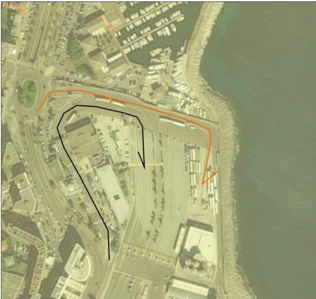
Possible développement du système d'accès au Port de Bastia (en noir l'accès des véhicules passagers et en orange ceux des véhicules de marchandises)
