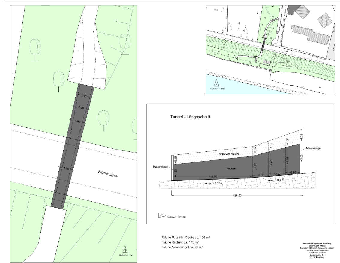
Lage des Tunnels, Querschnitt und Anzahl Beleuchtungskörper
