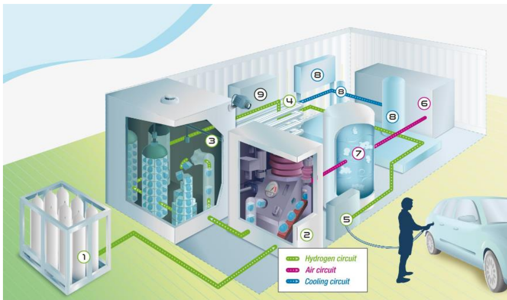
Figur 4: Eksempel på oppsett av en hydrogenfyllestasjon: (1) Hydrogenkilde, (2) Kompressor, (3) Buffere/lagring under høyt trykk, (4) Utskylere/kjøling, (5) Dispenser, (6) Trykkluftkompressor, (7) Lagringstank for trykkluft, (8) Kjøler/frysevæske, (9) Strømskap/styringssystem. (Kilde: H2ME/Air Liquide).
