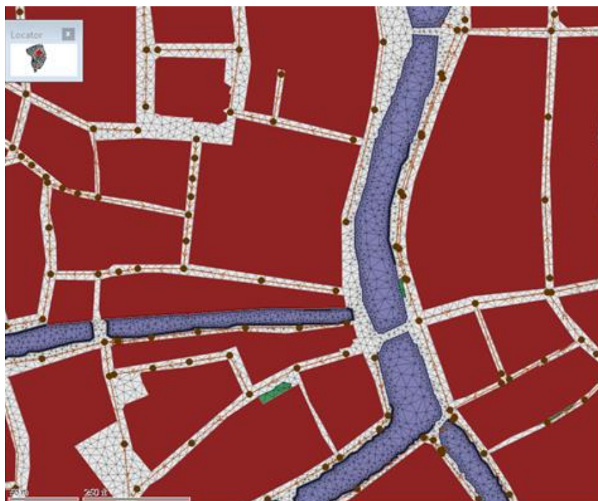
Figuur 17. Aangepast 1D-2D simulatiemodel waarbij een rekenraster voor de oppervlakte werd toegevoegd.
