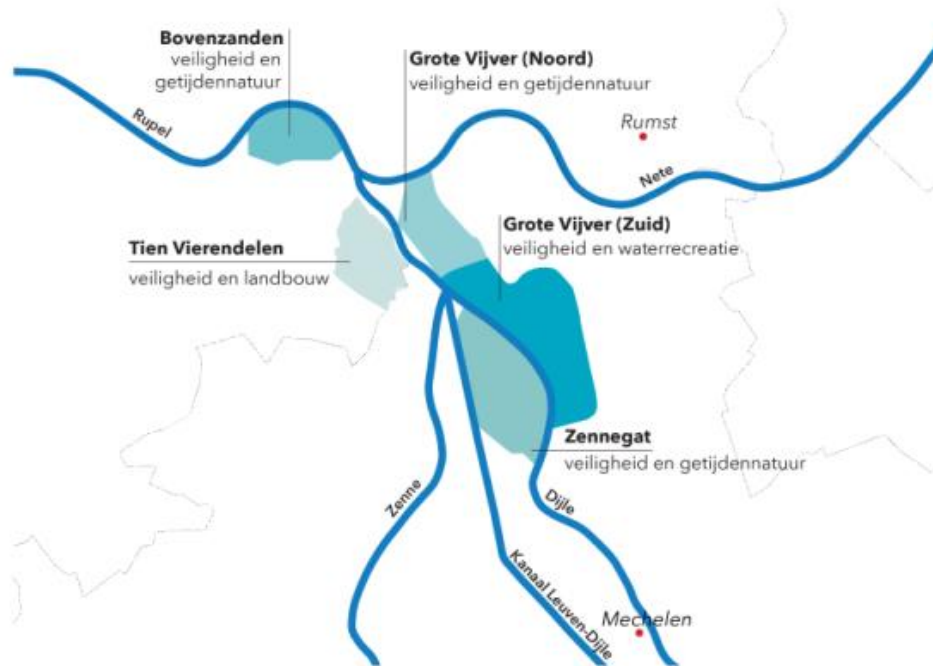
Figuur 3.18: Overstromingsgebieden van de Grote Vijver en het Zennegat [13].
