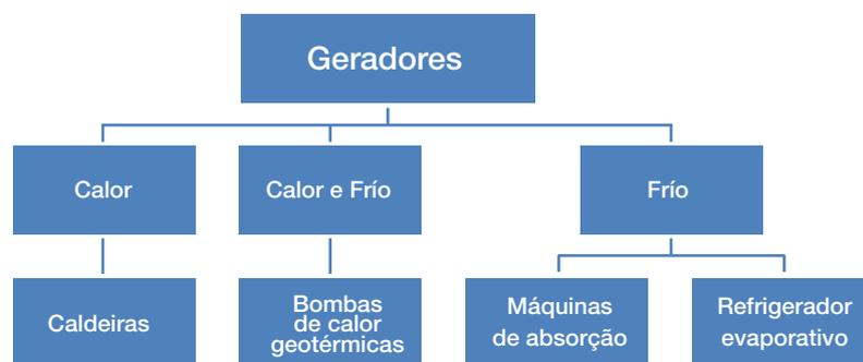
Figura 22: Figura resumo com os sistemas de geração
