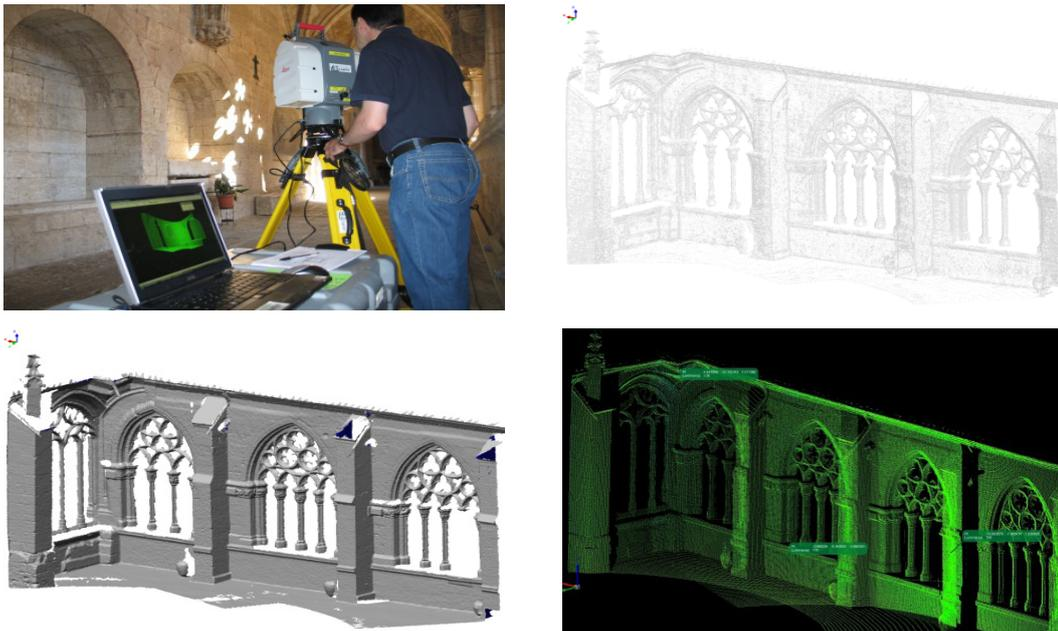
Figura 2: Dados recolhidos por um scanner laser (LEICA HDS3000): conjunto de pontos, malha e índice de reflectividade
