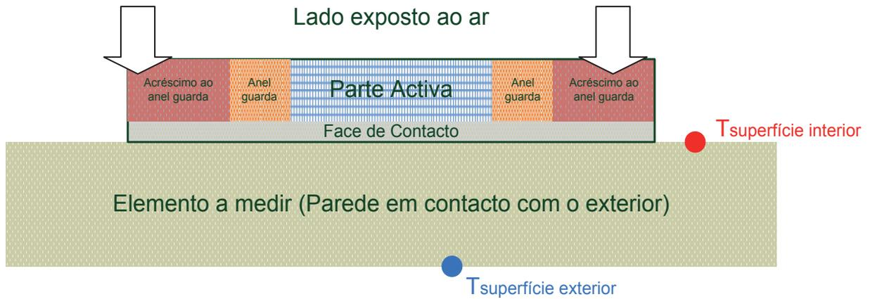
Figura 8: Exemplo da secção de um fluxímetro de calor
