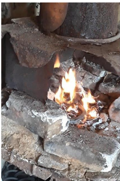
Зачервяване на метала за подковата
