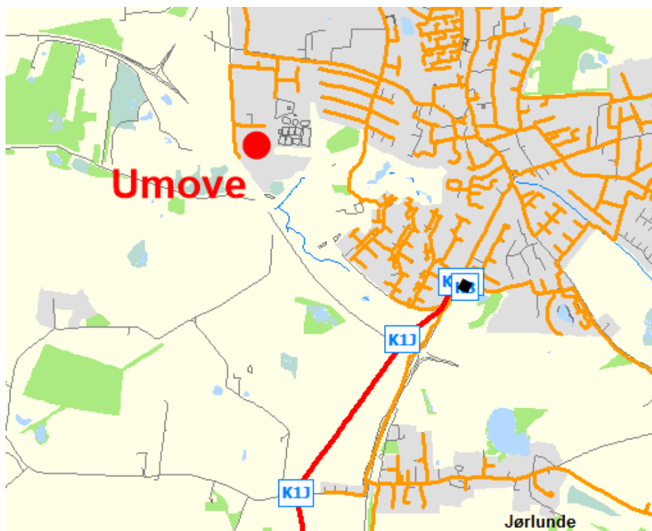
Figur 12 Slangerup - Garageanlæg tilhørende Umove. Rød linje er 20 bar fordelingsrør og orange linje er 4 bar distributionsrør.
