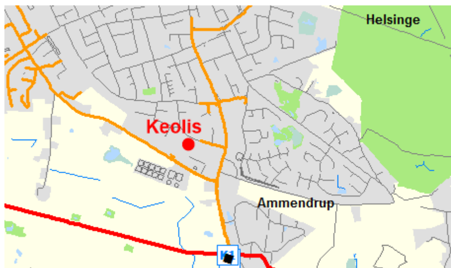
Figur 13 Helsingø - Garageanlæg tilhørende Keolis. Den røde linje er 20 bar fordelingsrør. Den orange linje er 4 bar distributionsrør.
