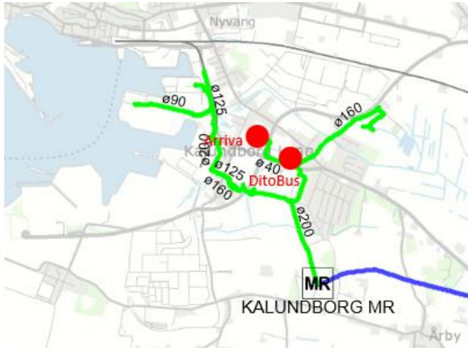
Figur 9 Kalundborg - Garageanlæg tilhørende Arriva og DitoBus. Den blå linje er 19/40 bar fordelingsrør og den grønne linje er 4 bar distributionsrør
