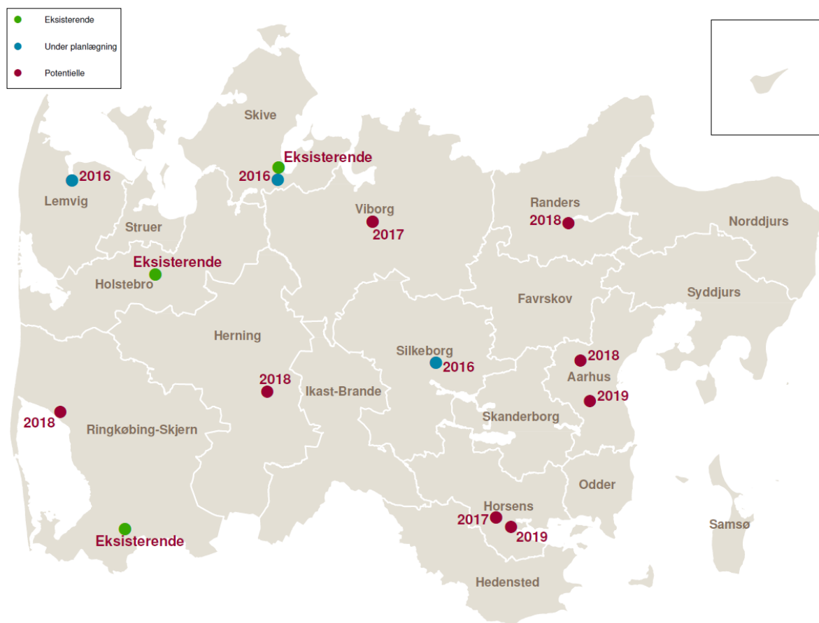
Figur 11: Infrastrukturscenarie for etablering af gastankstationer i Region Midtjylland fra 2016 til 2020 (de grønne prikker illustrerer placeringen af eksisterende gastankstationer, de røde prikker illustrerer placeringen af potentielle gastankstationer samt etableringsåret, mens de blå illustrerer placeringen af gastankstationer under planlægning).
