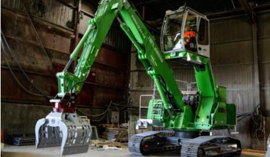
Figur 26: Elektrisk sorteringsgravemaskin (Daler, 2016).
