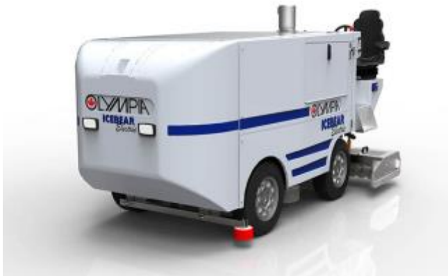
Figur 39: Batterielektrisk isprepareringsmaskin (Isbaneteknikk AS, n.d.-b).
