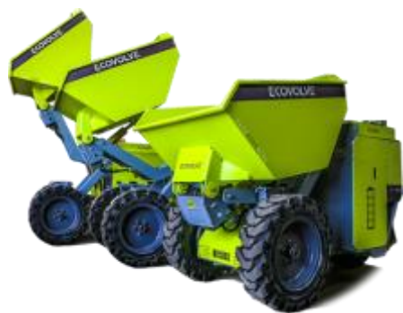
Figur 31: Batterielektrisk mini hjuldumper fra Ecovolve (Ecovolve, n.d.).
