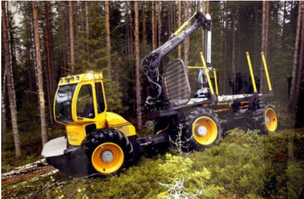
Figur 15: Diesel-elektrisk hybrid lastetraktor (Lidén, 2009).
