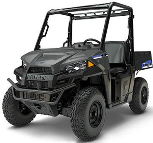
Figur 14: Batteridreven EU-traktor (Polaris).
