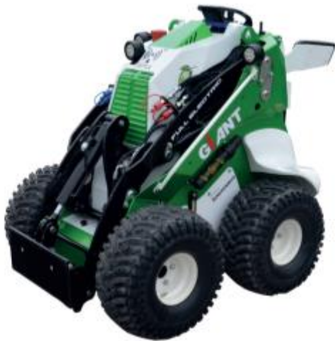
Figur 29: Batterielektrisk hjullaster (Tobroco)
