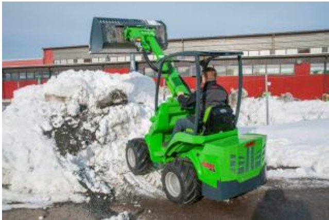
Figur 17: Elektrisk hjullaster (Avant, n.d.).
