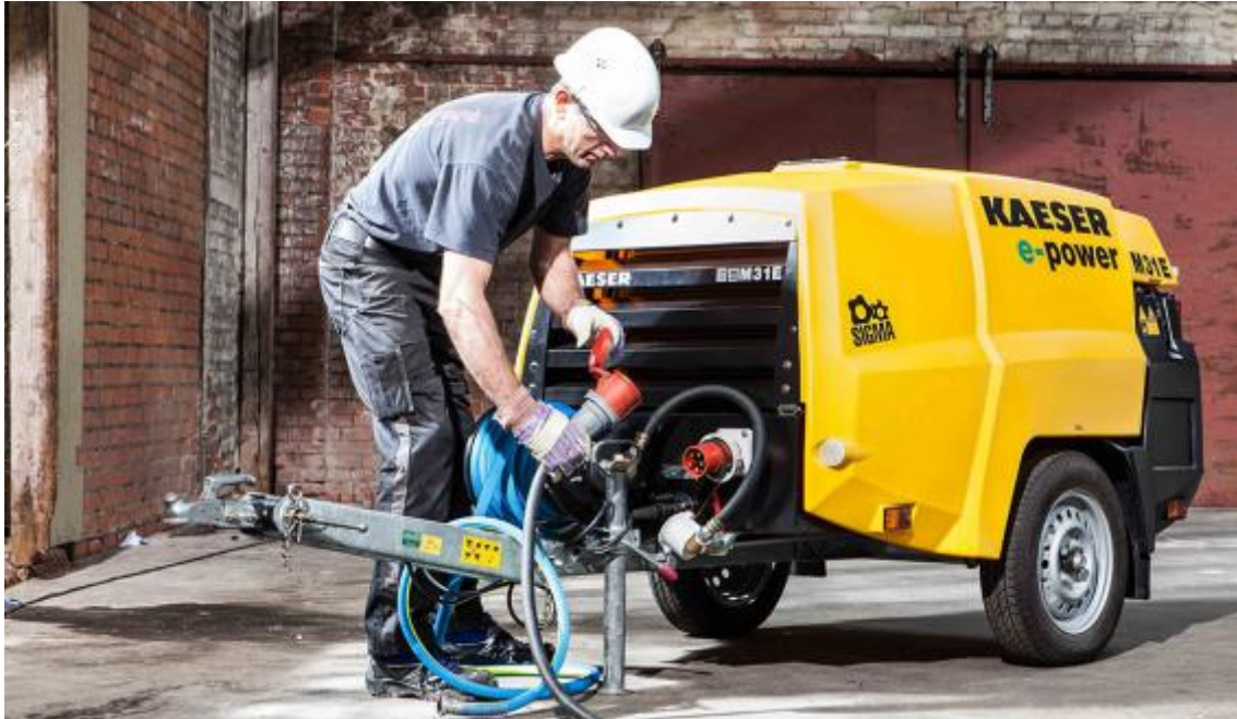
Figur 36: Elektrisk anleggskompressor (Søderholm, 2016).
