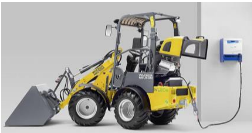
Figur 18: Elektrisk hjullaster (Wacker Neuson, 2016e).
