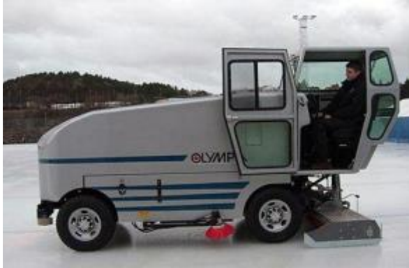
Figur 38: Isprepareringsmaskin på naturgass eller biometan (Isbaneteknikk AS, n.d.-d).
