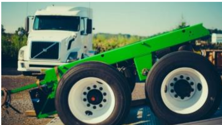
Figur 3: Ettermontering av hybridlinje på semitrailer (Valle, 2016).
