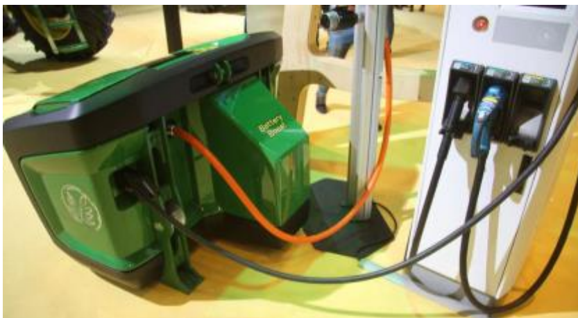
Figur 11: Frontlodd med batteri og uttak til strøm og hydraulikk (Syljuåsen, 2016a).
