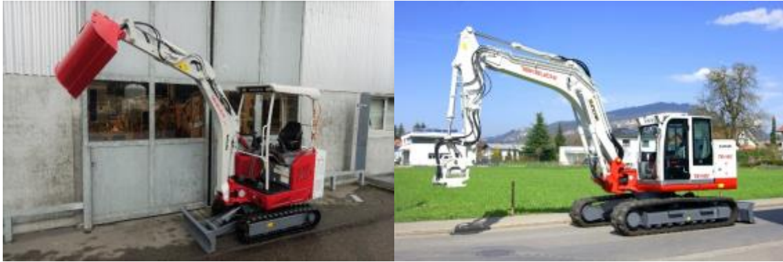
Figur 24: batterielektriske beltegravere (SUNCAR HK AG, n.d.).
