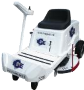
Figur 41: batterielektrisk sitte-kantfreser (Isbaneteknikk AS, n.d.-a).
