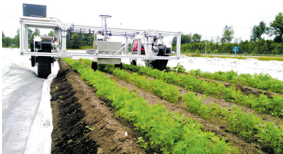
Vid Seges i Danmark håller man på att utveckla senstyrd mekanisk ogrärensning i radodlingsgrödor. Med kamerateknik skall man kunna bedömma ogräseffekten av radrensningen genom att mäta resultatet innan och efter körningarna.
