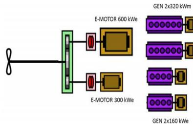
12. ábra: A DE2 hajtásrendszer sémája, A változat
