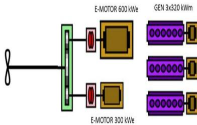
13. ábra: A DE2 hajtásrendszer sémája, B változat
