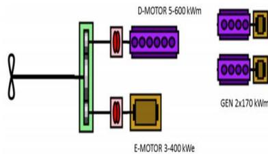
14. ábra: A HIBRID hajtásrendszer sémája, A változat
