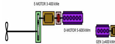
15. ábra: A HIBRID hajtásrendszer sémája, B változat
