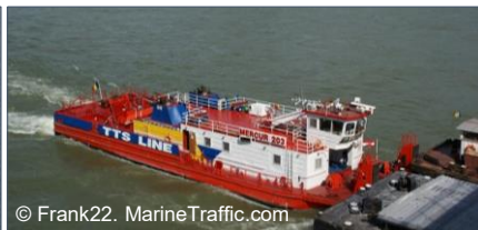
Type 2 pusher: 2 x 895 kW/1800rpm
