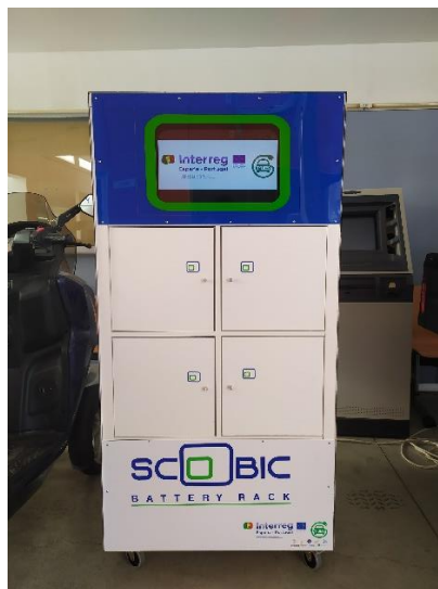
Figura 6. Vista frontal del stack de baterías con compartimentos cerrados.
