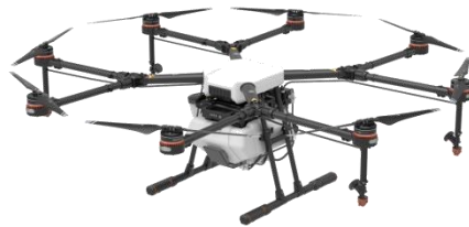
Plataforma de trabajo. Vehículo aéreo pilotado remotamente (RPA)
