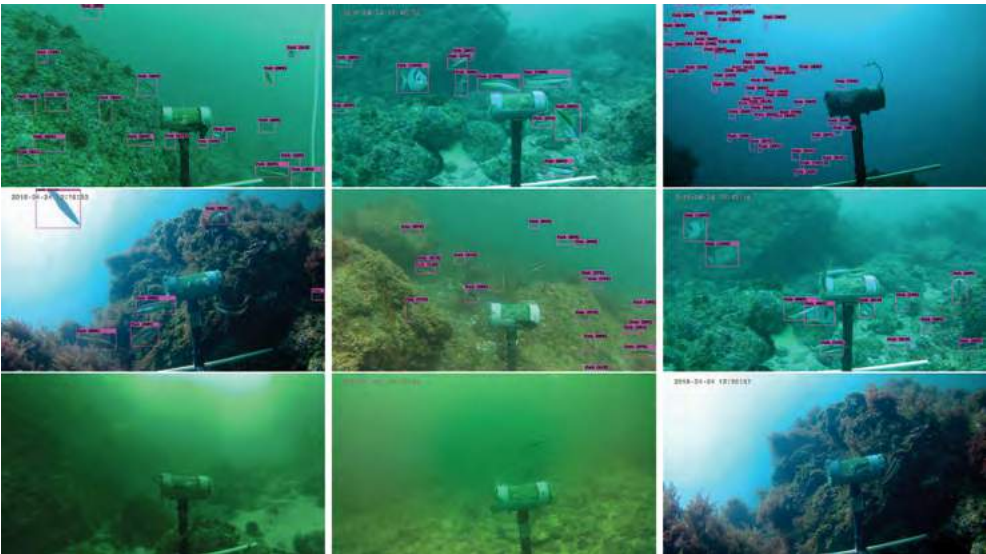
Figura 8. Amostra de deteção instantânea correta sobre quadros obtidos da filmagem do CCMAR. Linha superior, deteções corretas. Linha do meio, deteções parcialmente corretas. Linha inferior, casos de falha.
