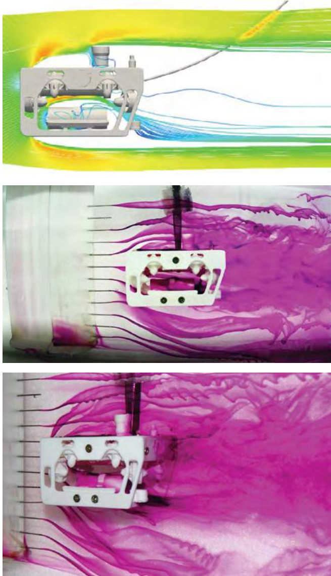
Figura 24. Comparación de las trayectorias de las líneas de corriente simuladas con los modelos CFD y las obtenidas con ensayos experimentales en la interacción flujo-ROV.
