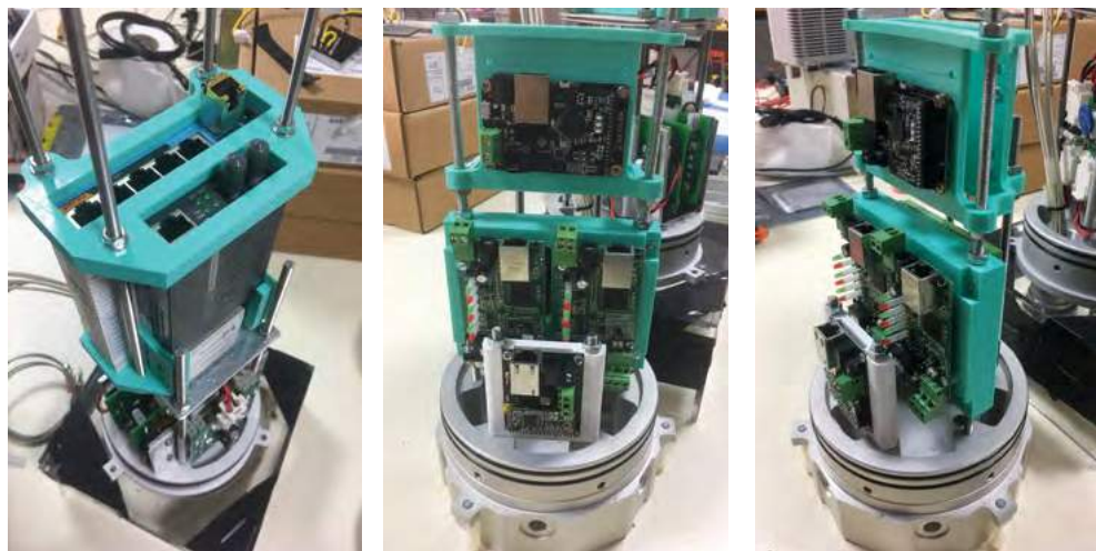
Figura 11. Conversor de fibra e o router (esquerda), módulos PLC (centro) e conversores de RS232/485 para ethernet (direita).
