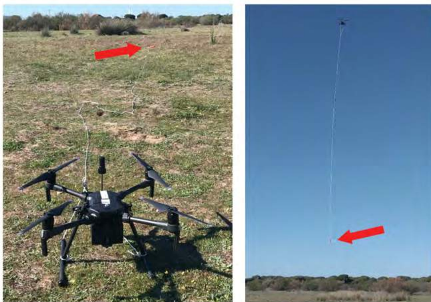
Figuras 18 a y b. UAV con sonda CTD acoplada a la aeronave y la misma después de despegar con la sonda lista para ser usada. Las flechas rojas señalan la ubicación de la sonda
