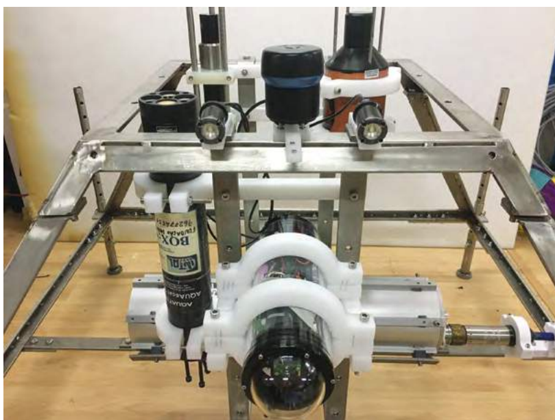
Figura 8. Foto da estrutura da estação subaquática com detalho dos equipamentos (face lateral da área da câmara/sonar)
