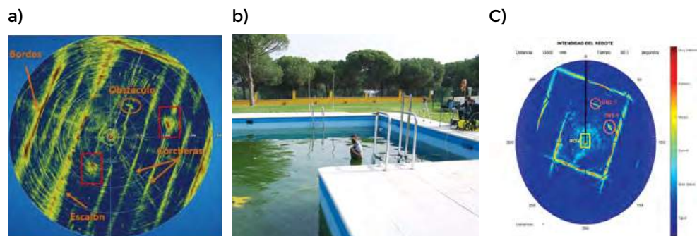
Figura 5. a) Medidas proporcionadas por el sonar; b) Experimentación en piscina; c) Información procesada proporcionada al operador en el interfaz de usuario.
