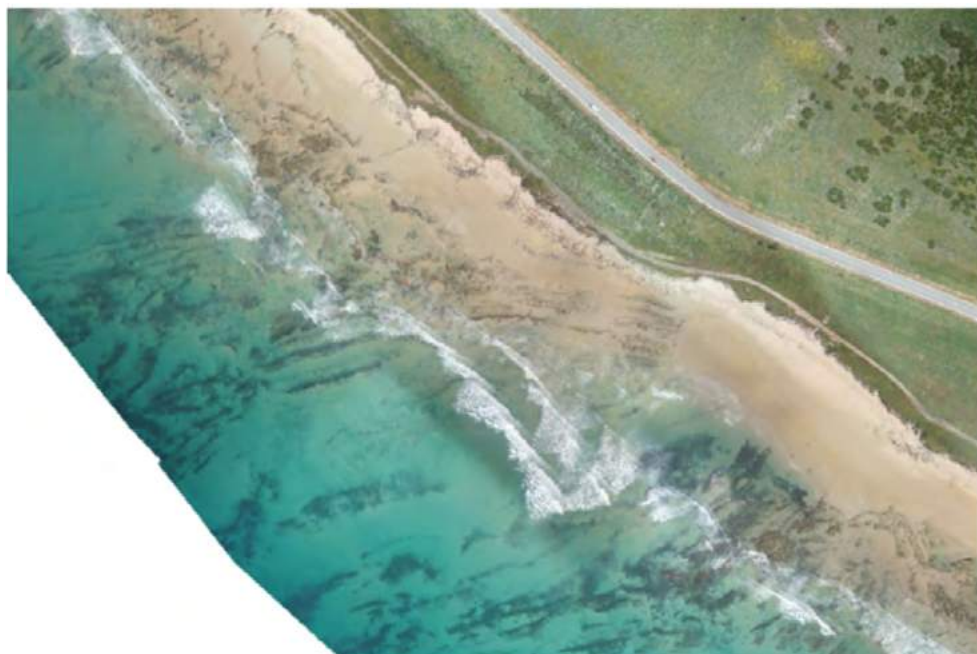
Figura 8. Detalla de un ortomosaico realizado en un sector de 4 km de la costa de Cádiz, en el que puede observarse que, si la lámina de agua es transparente y el fondo contiene información visual, es posible reconstruir no solo la topografía de la parte emergida sino también parte del sector intermareal o submareal
