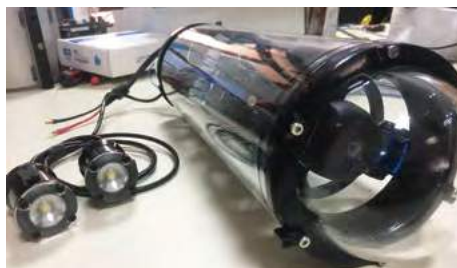
Figura 17. Foto do contentor da câmara da bluerobotics e as respetivas luzes de iluminação
