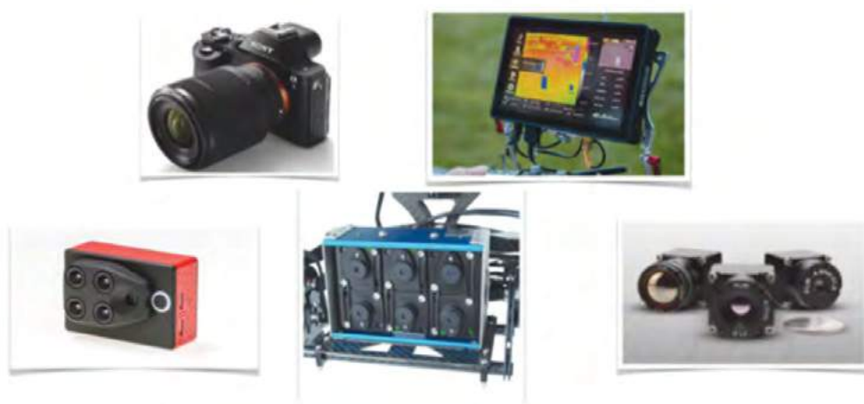
Figura 4. Distintos tipos de sensores embarcados en drones. De izquierda a derecha y arriba abajo: Sensor RGB, pantalla de control de sensor térmico; sensor multi-espectral de cuatro bandas y RGB; sensor multispectral de seis bandas; sensores térmicos (elaboración propia)
