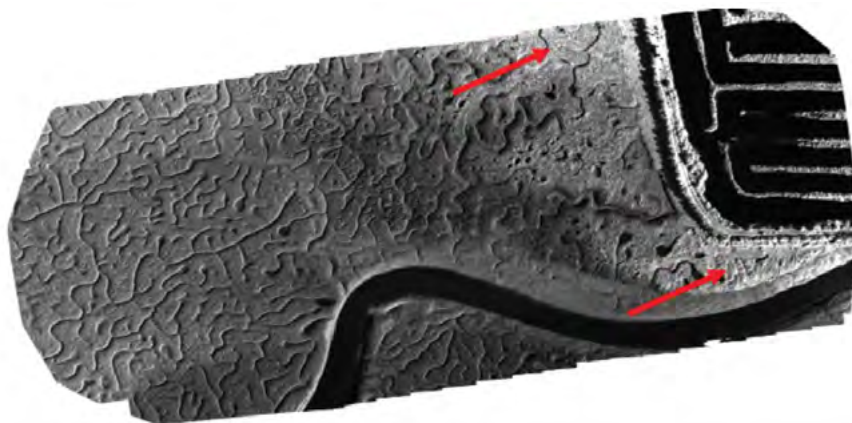
Figura 14. Imagen de reflectancia de la misma zona que en la fotografía 13, pero en la banda del infrarrojo cercano o NIR (842 nm). Obsérvese que en esta imagen la vegetación aparece de color más claro (zonas señaladas por flechas de color rojo) porque las plantas son muy activas en la reflexión de luz infrarroja, (datos propios)
