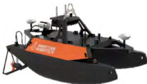
Figura 4. USV Maritime Robotics modelo Otter Pro, perteneciente a la Sección de Vehículos Marinos no Tripulados de la Universidad de Cádiz ( https://dron.uca.es/vehiculos-marinos/ )
