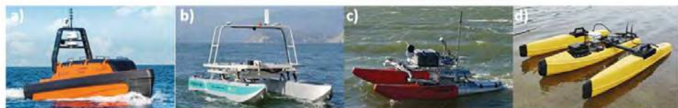
Figura 10. USV comerciales con distintas configuraciones y esloras: a) Monocasco Sounder de 8 m de eslora, de Kongsberg ; b) Catamarán HydroCat-180 de 5,5 m de eslora, de Seafloor Systems ; c) Catamarán hinchable WAM-V 8 de 2,5 m de eslora, de Marine Advanced Robotics ; y d) Trimarán Z-Boat 1250 de 1,27 m de eslora, de Teledyne
