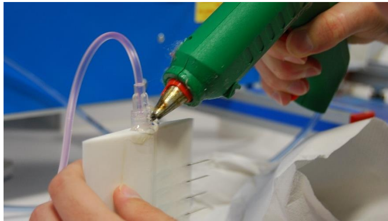
Figura 74. Pegado de la conexión del gotero al colector.
