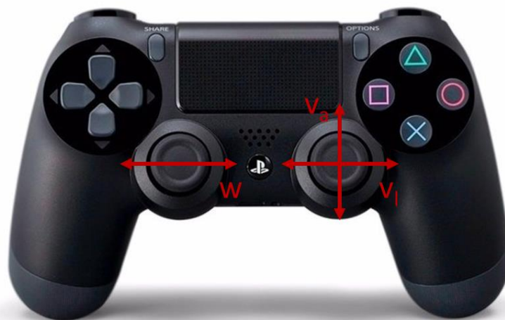
Fig. 25. Control del ROV mediante el mando
