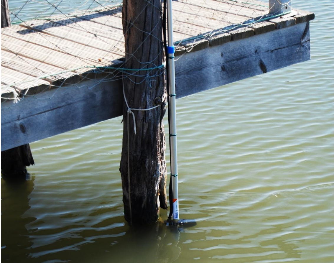
Fig. 13 Transductor del sonar de imagen LVS32 de Garmin, acoplado a un módulo LiveScope GLS10 (Sistema Panoptix LiveScope™).
