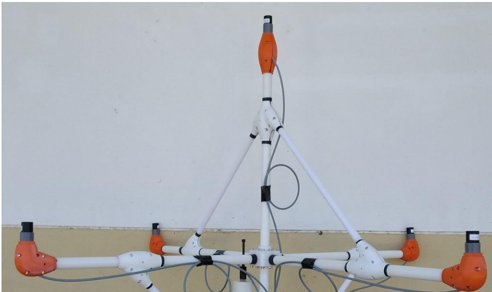
FIGURA 18 - ARRAY COM 4 HIDROFONES E 1 VECTOR SENSOR
