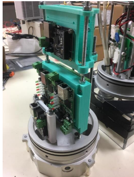
FIGURA 9 - MÓDULOS PLC E CONVERSORES DE RS232/485 - ETHERNET
