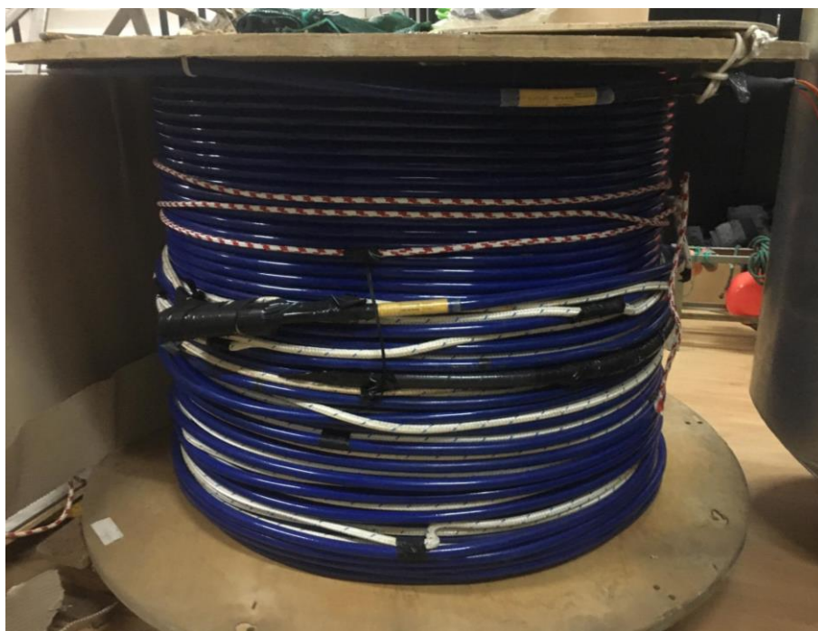
FIGURA 23 – CABO DE LIGAÇÃO DE FIBRA ÓTICA E ENERGIA
