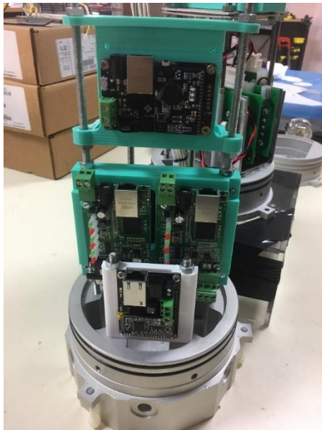
FIGURA 9 - MÓDULOS PLC E CONVERSORES DE RS232/485 - ETHERNET
