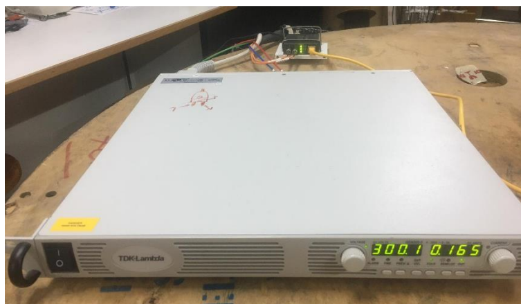
FIGURA 2 - FONTE DE ALIMENTAÇÃO TDK-LAMBDA GEN 300-5
