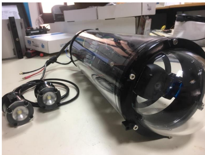
FIGURA 14 – CONTENTOR DA CÂMARA DA BLUEROBOTICS E AS RESPETIVAS LUZES DE ILUMINAÇÃO
