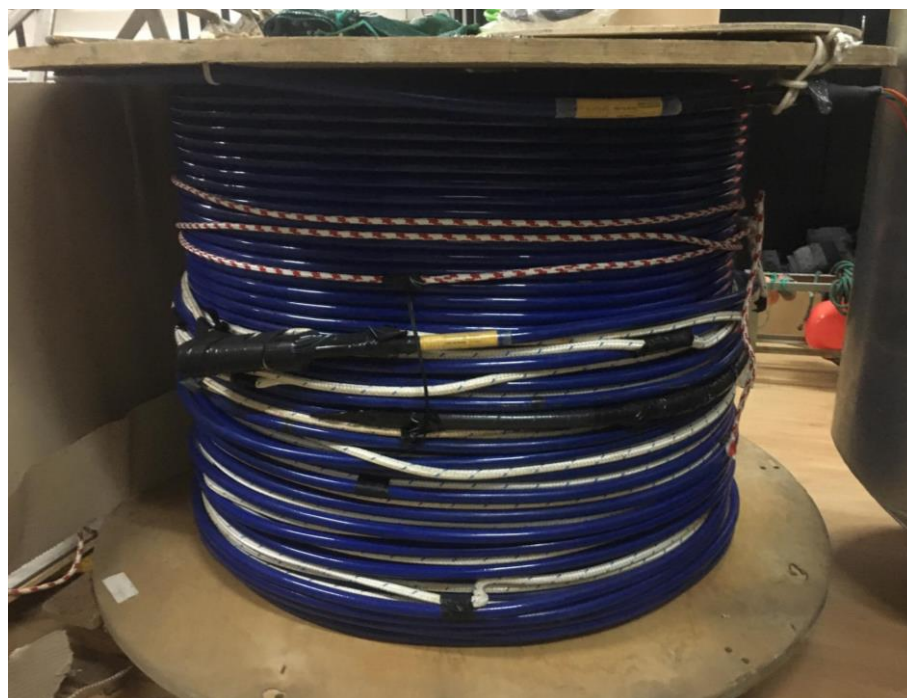
FIGURA 25 – CABO DE LIGAÇÃO DE FIBRA ÓTICA E ENERGIA
