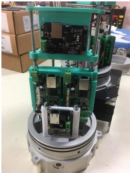
FIGURA 12 - MÓDULOS PLC E CONVERSORES DE RS232/485 - ETHERNET
