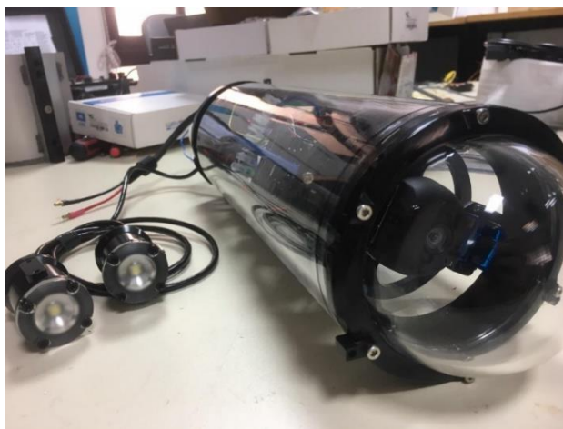
FIGURA 18 – CONTENTOR DA CÂMARA DA BLUEROBOTICS E AS RESPECTIVAS LUZES DE ILUMINAÇÃO
