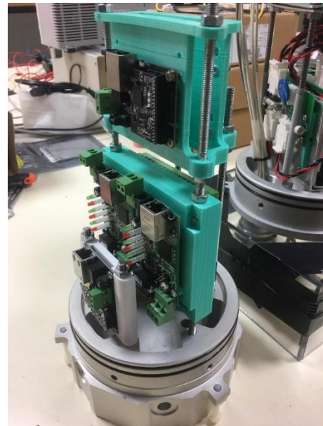
FIGURA 12 - MÓDULOS PLC E CONVERSORES DE RS232/485 - ETHERNET
