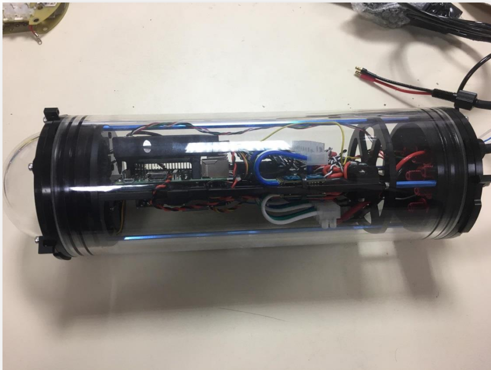
Fotografía 10. Equipos adquiridos por la Universidad del Algarve. Tubo BlueRov2 con cámara y placa de control incluida para el sistema fijo
