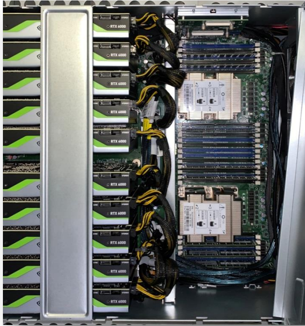
Fotografía 9. Equipo adquirido por la Universidad de Huelva. Servidor cluster GPUs con 2 CPUs Intel Xeon Gold 6230 de 2.1 GHz (turbo 3.9 GHz), 512 GB de RAM y 10x GPUs NVIDIA Quadro RTX6000 con 24 GB cada una
