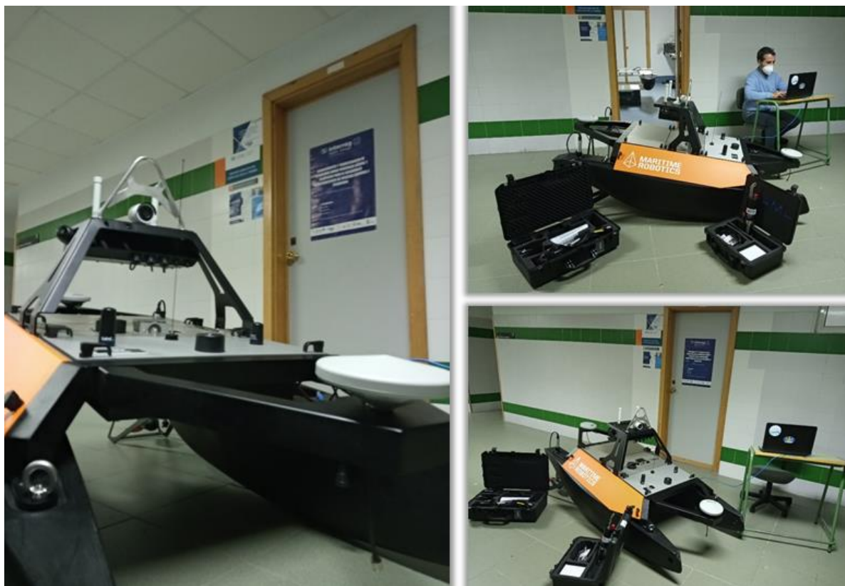
Fotografía 5. Equipos adquiridos por la Universidad de Cádiz. USV Otter Pro con sistema de navegación inercial APPLANIX SurfMaster, sistema de adquisición de datos y sonar de velocidad del sonido en el agua SVP AML
