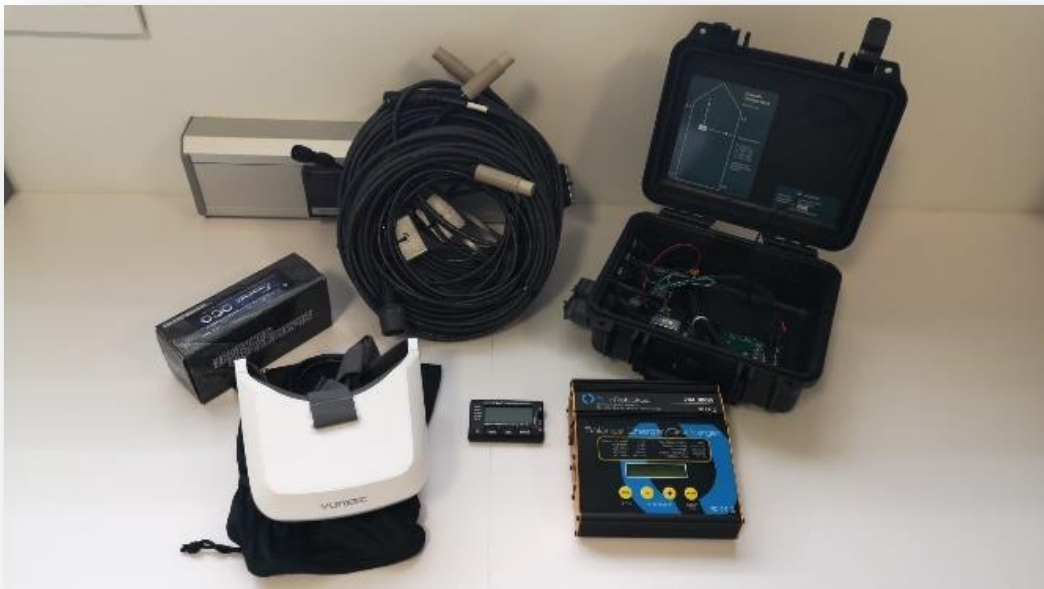
Fotografía 8. Equipo adquirido por la Universidad de Huelva. Sistema de posicionamiento GPS por balizas
