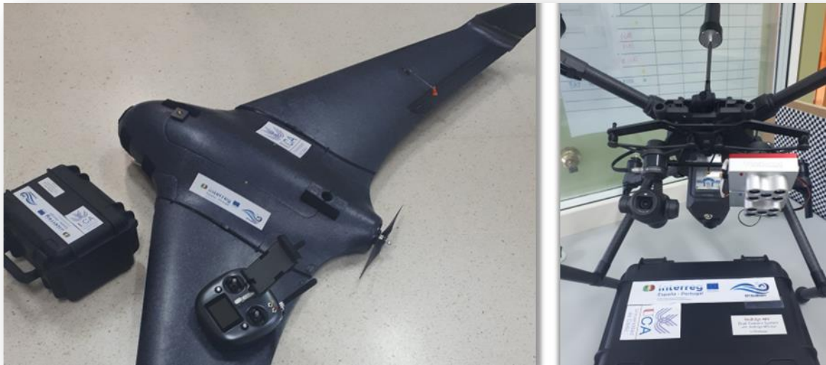
Fotografía 1. Equipos adquiridos por la Universidad de Cádiz. Izquierda: Dron de ala fija modelo FV1; Derecha: Cuadrícóptero en el que se ha instalado la cámara multiespectral de diez bandas MicaSense RedEdge
