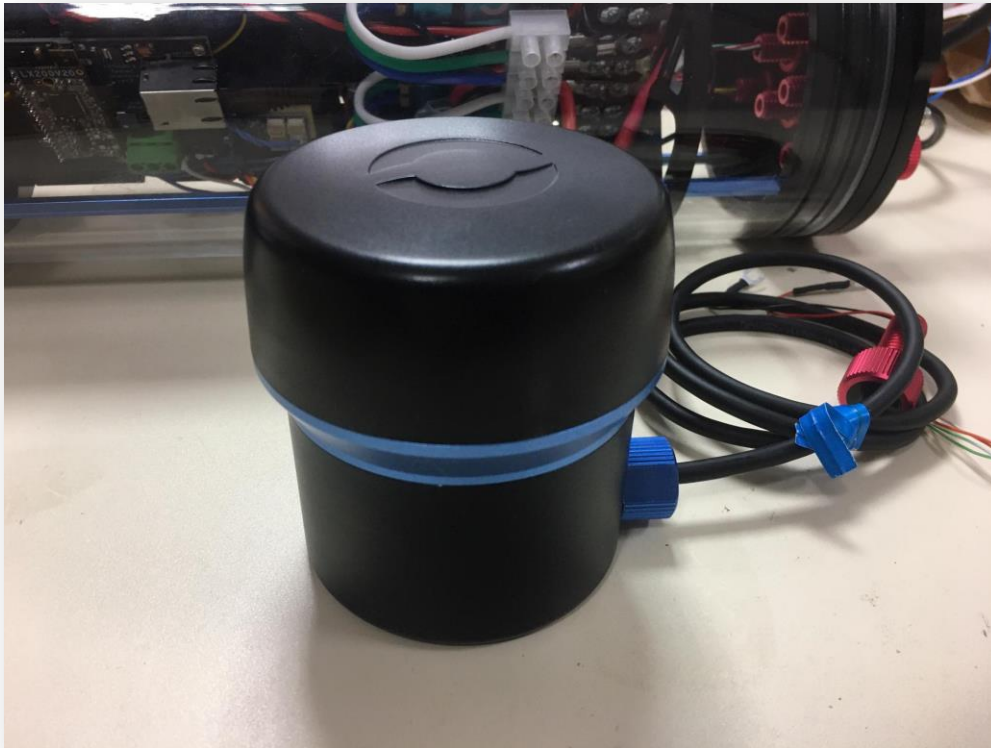
Fotografía 11. Equipo adquirido por la Universidad del Algarve. Escaner Ping360 para instalar en sistema fijo
