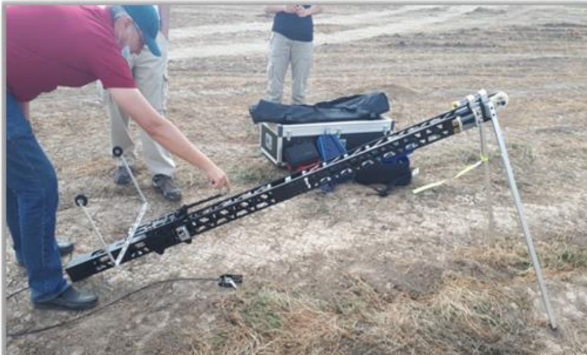
Fotografía 2. Equipos adquiridos por la Universidad de Cádiz. Lanzadera del dron de ala fija modelo FV1
