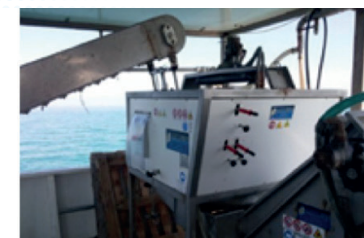
Fig. 31 - Sgranatrice a bordo di una imbarcazione impiegata per la miticoltura.
