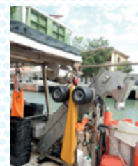
Fig. 30 - Incalzatrice a bordo di imbarcazione
