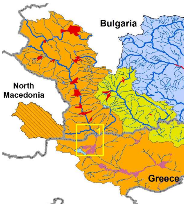
Χάρτης 4.2. Ζώνες Δυνητικά Υψηλού Κινδύνου Πλημμύρας (ΖΔΥΚΠ) (APSF: Areas of Potential Significant Flood Risk) στη Βουλγαρική λεκάνη του ποταμού Στρυμόνα (κόκκινα πολύγωνα), και περιοχές υψηλού κινδύνου πλημμύρας (T=100 έτη) στο Ελληνικό τμήμα της λεκάνης (μωβ πολύγωνα). Το αριθμημένο κίτρινο πολύγωνο δείχνει την περιοχή όπου ενδέχεται να παρουσιάζονται πλημμύρες λόγω διασυνοριακότητας.
