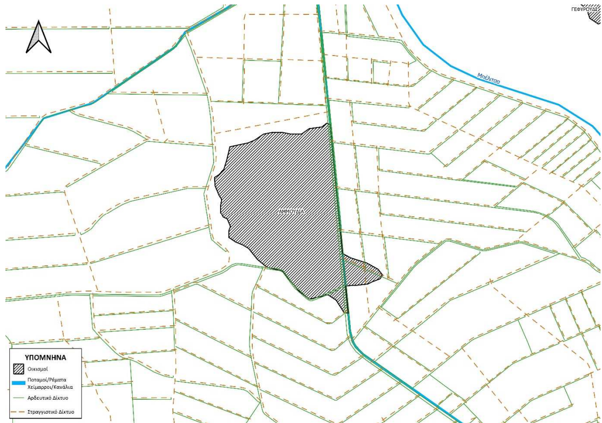
Εικόνα 3.1.9 : Το αρδευτικό και στραγγιστικό δίκτυο κοντά στον οικισμό Αμμουδιά
