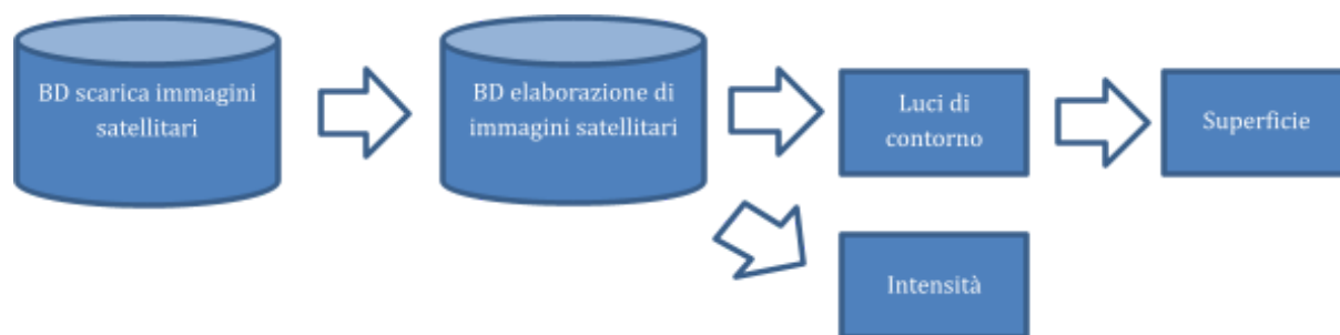
Figura 10 : Automazione della catena di elaborazione del CES Fire (Fonte : INRAE UR RECOVER, 2020)
