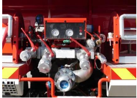
Pompa CCFM : Capacità 2000l/min a 5 bar
