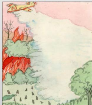
Lanci di protezione tra il fronte e gli operatori a protezione delle squadre a terra
