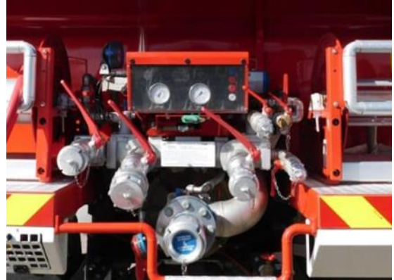
Pompa CCFM : Capacità 2000l/min a 5 bar
