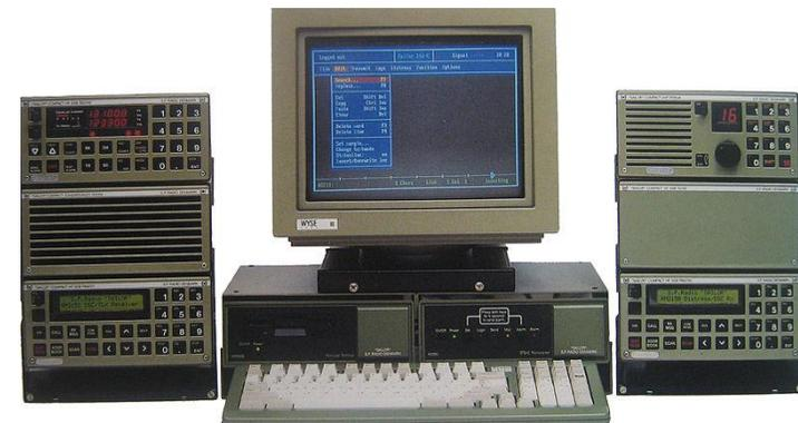
Le SMDSM permet des Appels Sélectifs Numériques ASN ou DSC (*Digital Selective Call*) par les émetteurs-récepteurs en VHF et par les émetteurs-récepteurs MF/HF pourvus de l'ASN.
