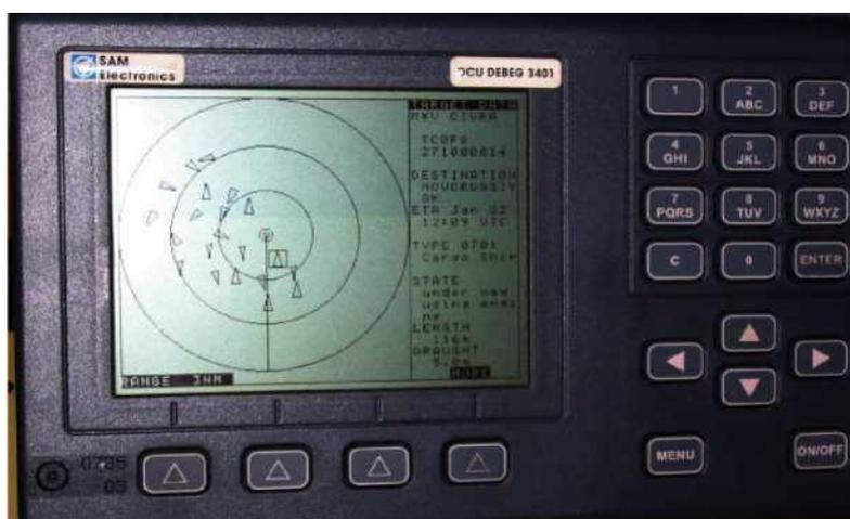
Les informations fournies par l'équipement AIS, telles que l'indicatif d'appel MMSI du navire, sa position et sa vitesse, peuvent être interfacées avec les systèmes radar embarqués et / ou affichées sur un écran dédié, similaire au PPI d'un radar, ou sur un ECDIS (Electronic Chart Display Information System).
