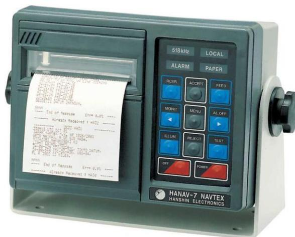
Le NAVTEX a été développé dans le but de créer un système à faible coût, simple à utiliser et automatique, capable de recevoir des informations relatives à la sécurité de la navigation dans un rayon d'environ 200 miles de la côte.
