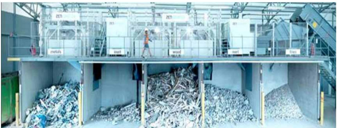
Figura 25. Imagen del sistema Finish ZenRobotics.
