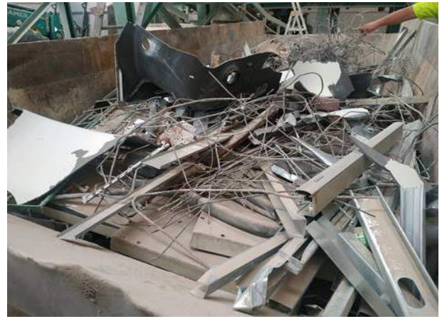
Figura 100. Contenedor con los restos metálicos tras el proceso de limpieza por imanes. Fuente: GAN-NIK
