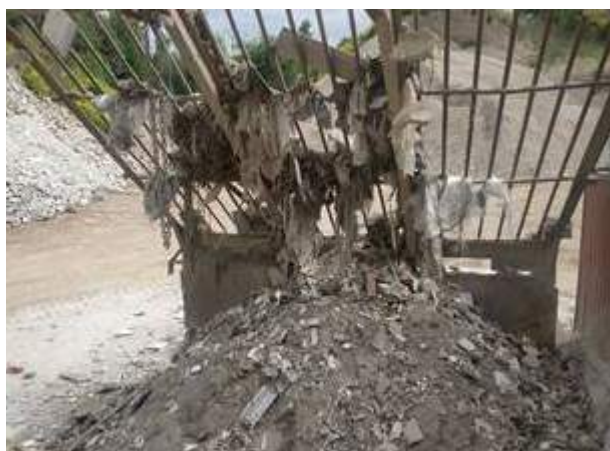
Figura 90. Detalle del sistema de cribado
