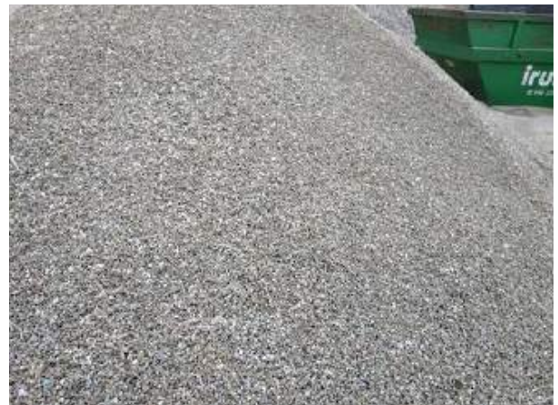
Figura 50. Acopio del árido reciclado de segunda de granulometría 20-30 Fuente: GAN-NIK
