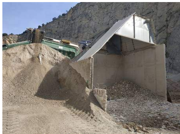
Figura 46. Material fino del primer tratamiento e improprios de los sopladores Fuente: GAN-NIK
