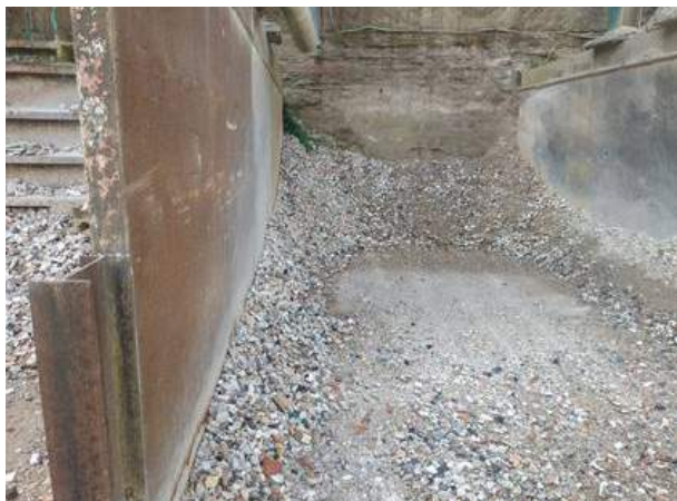
Figura 94. Fase final del proceso donde se acopian los áridos reciclados según su granulometría de Fuente: GAN-NIK
