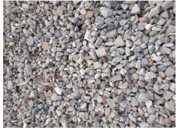
Figura 74. Acopio de grava de segunda
