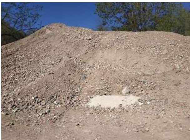
Figura 87. Acopio de los áridos reciclados producidos
