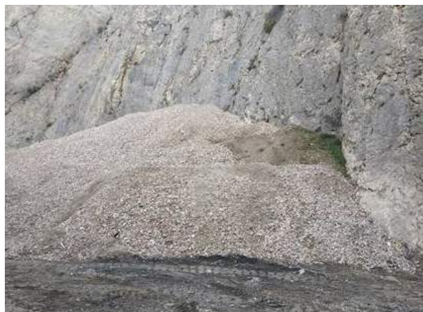
Figura 53. Acopio de árido mixto obtenido de la primera línea
