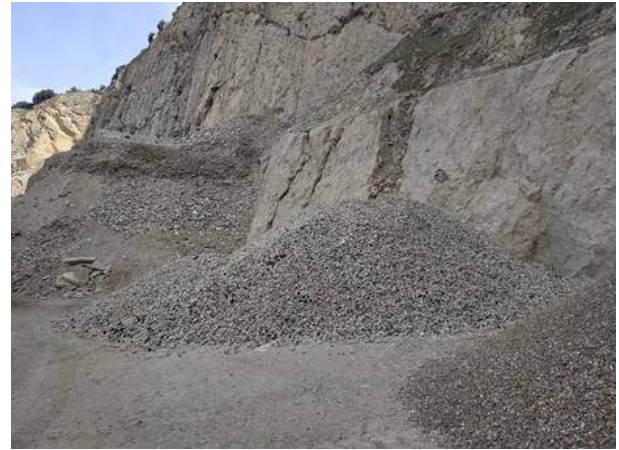
Figura 60. Acopio del árido reciclado con mayor proporción de hormigón
