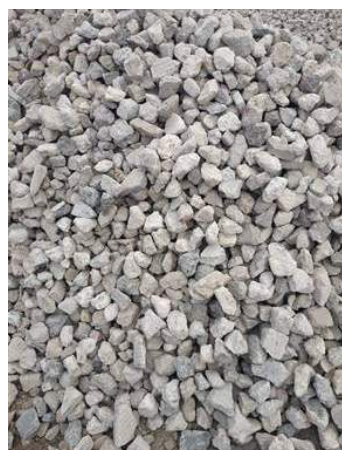
Figura 78. Detalle del acopio de grava de primera Fuente: GAN-NIK
