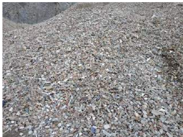
Figura 54. Detalle del acopio de árido mixto obtenido de la primera línea
