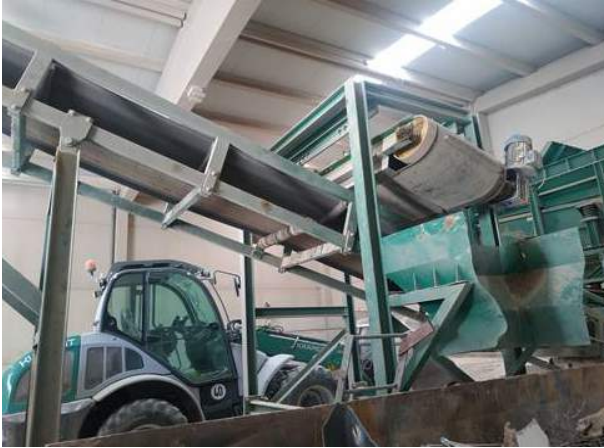
Figura 99. Detalle del imán de la instalación Fuente: GAN-NIK
