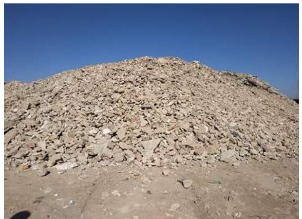
Figura 113. Escombros limpios antes de procesar
