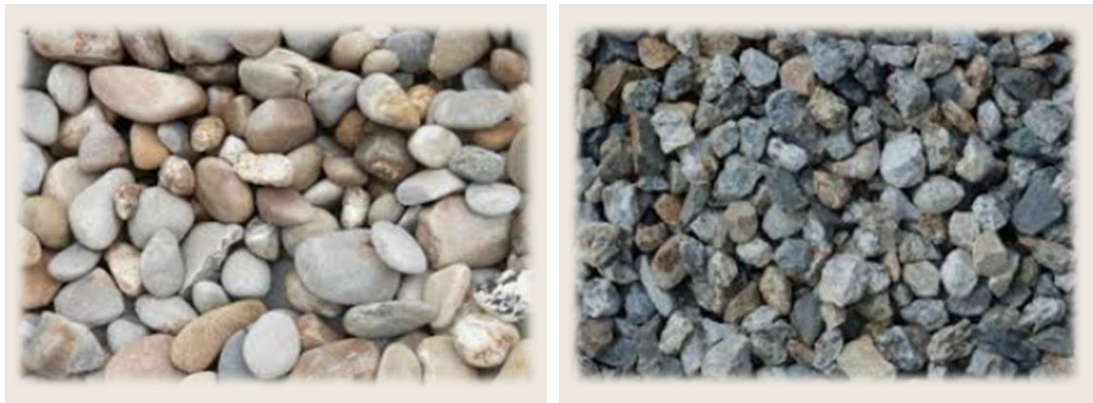
Figure 1-2: Granulats vierges roulés (gauche) et granulats vierges concassés (droite)
