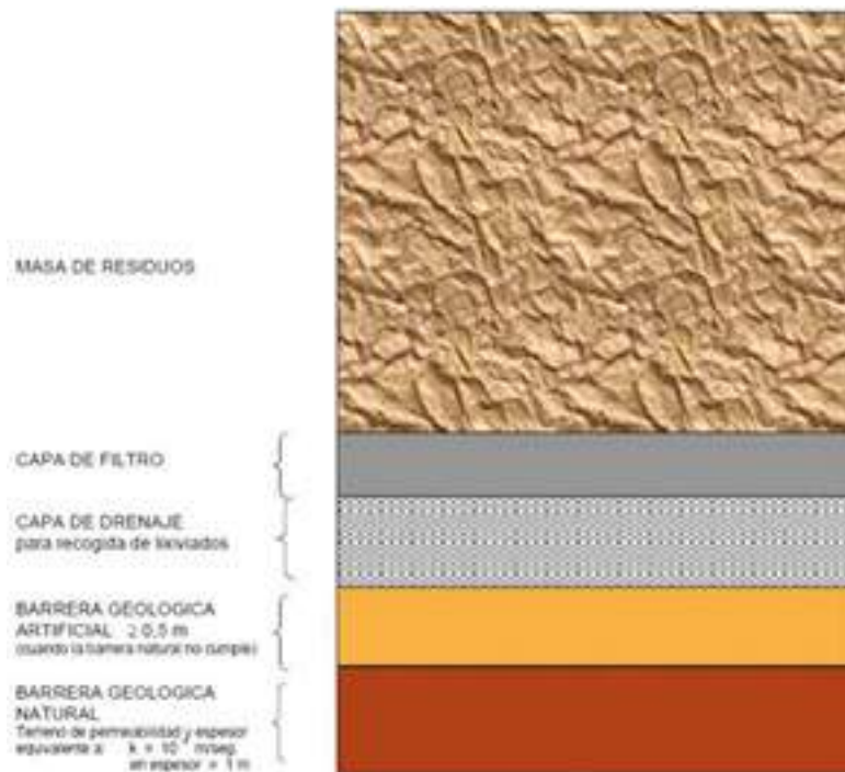
Figura 30. Esquema de referencia de restauración de huecos mineros con residuos inertes.
