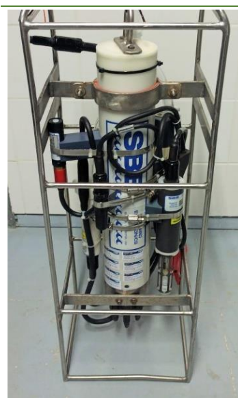
Foto 9. Sonda CTD SBE 19plus V2.
