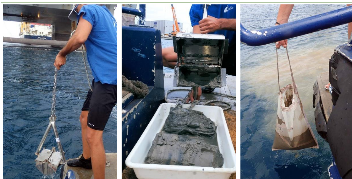
Foto 13. Muestreo con draga Van Veen.
