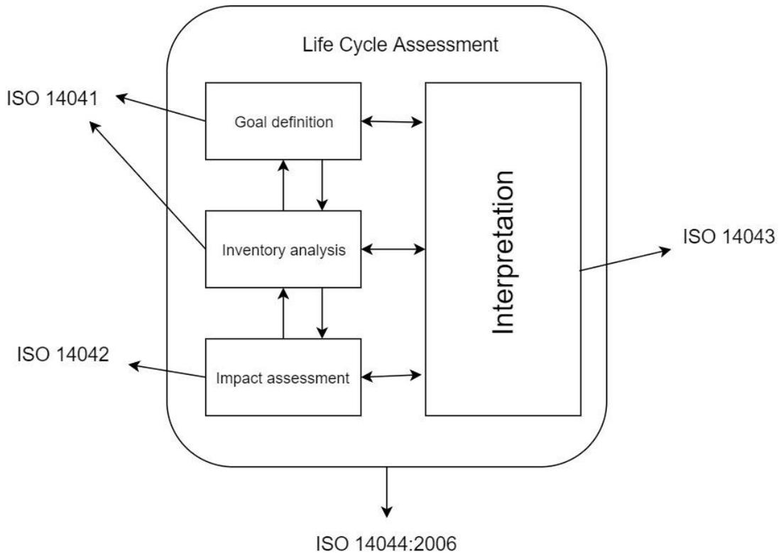
**FIGURE 13 LCA FRAMEWORK**
