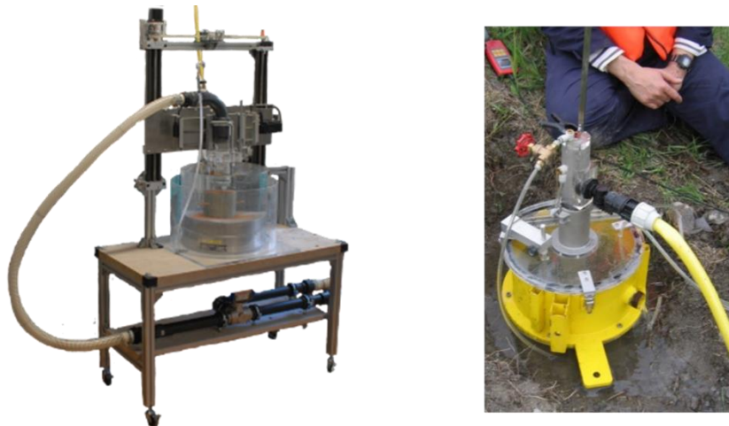
Figure 1. Essai de JET en laboratoire (à gauche) et essai de JET in-situ (à droite).
