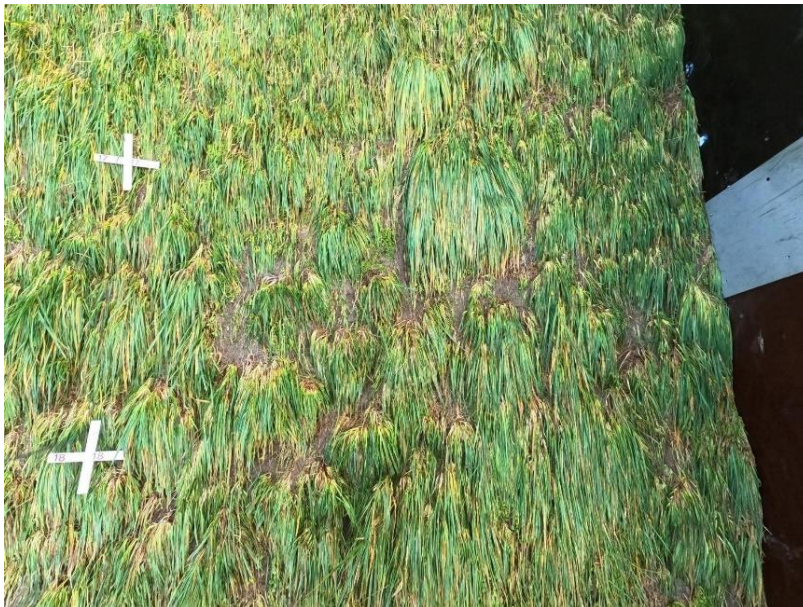
Figuur 26: Erosie in vak 17CD eind proef 0,5m60lsm
