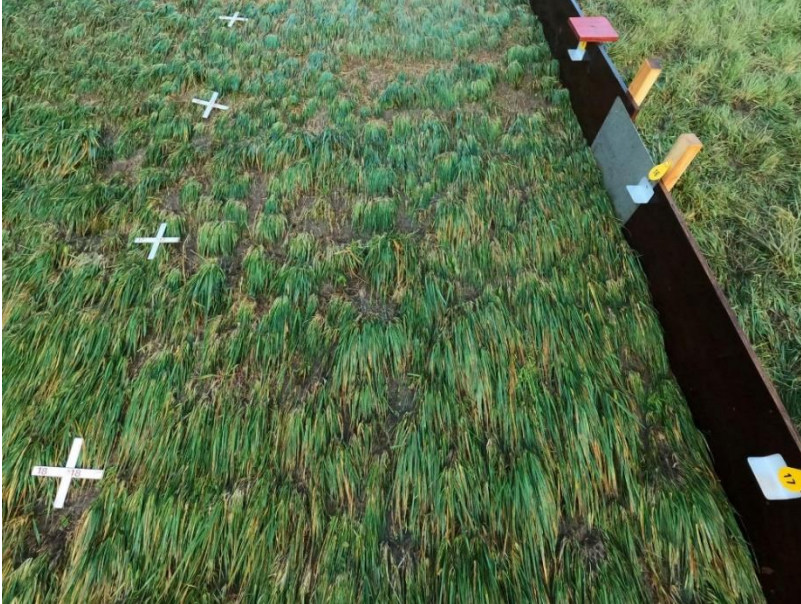
Figuur 8: Kale plekken in vakken 14-17CD na 1 stormuur van proef 0,5m60lsmov
