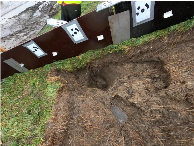
Figuur 40: Impressie erosiegat onderste sectie teststrook Kale klei 1 aan het einde van proef regelmatig 1.
