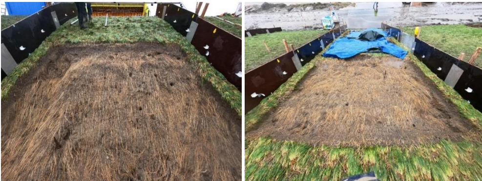
Figuur 42: Impressie bovenste sectie teststrook Kale klei 1 aan het einde van proef regelmatig 3.
