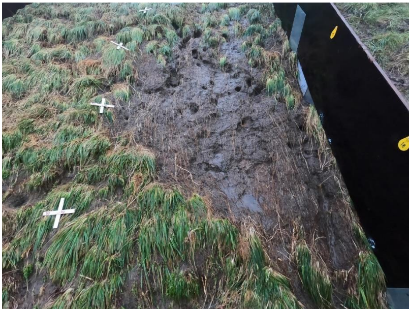
Figuur 17: Schadebeeld vakken 16-19CD aan het einde van proef 1m190lsm
