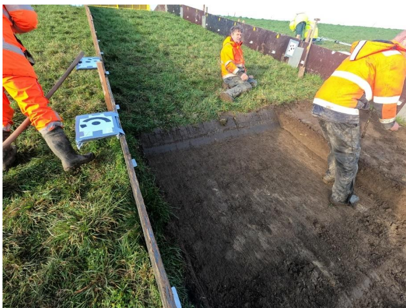
Figuur 38: Impressie onderste sectie teststrook Kale klei 1 na gedeeltelijk afgraven toplaag.
