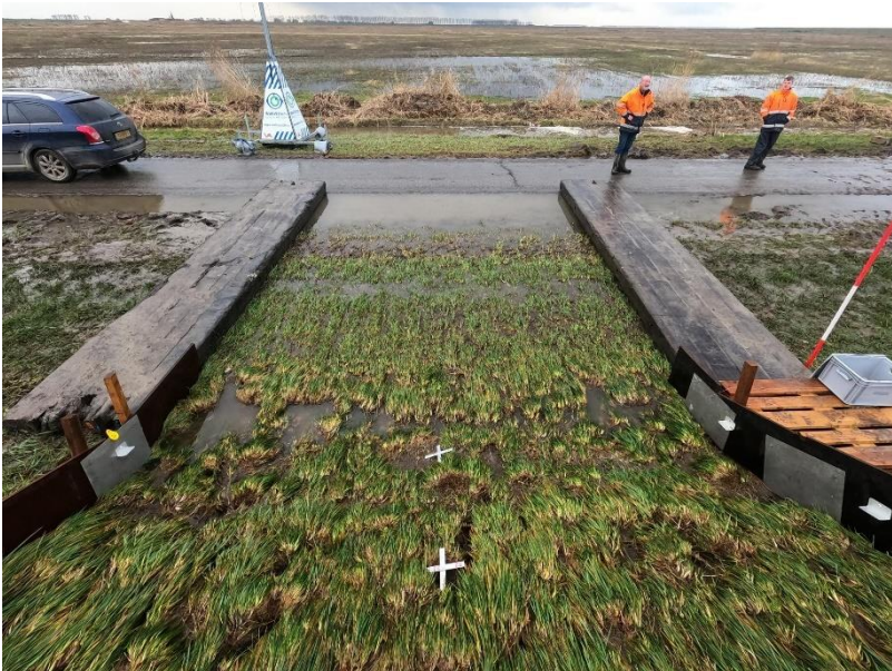
Figuur 11: Na één stormuur 1m190lsm waren de mollen gaten in vakken 21 en 22 verder uitgesleten en was de grindkoffer in vak 23 zichtbaar
