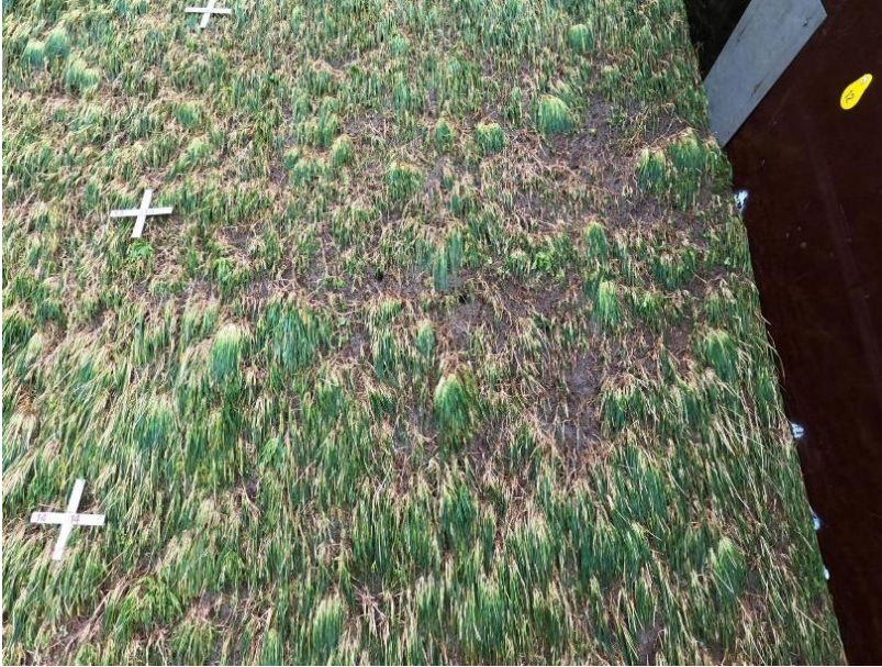
Figuur 30: Kale plekken in vakken 12-13CD na 4 stormuren met proef 1m190lsm
