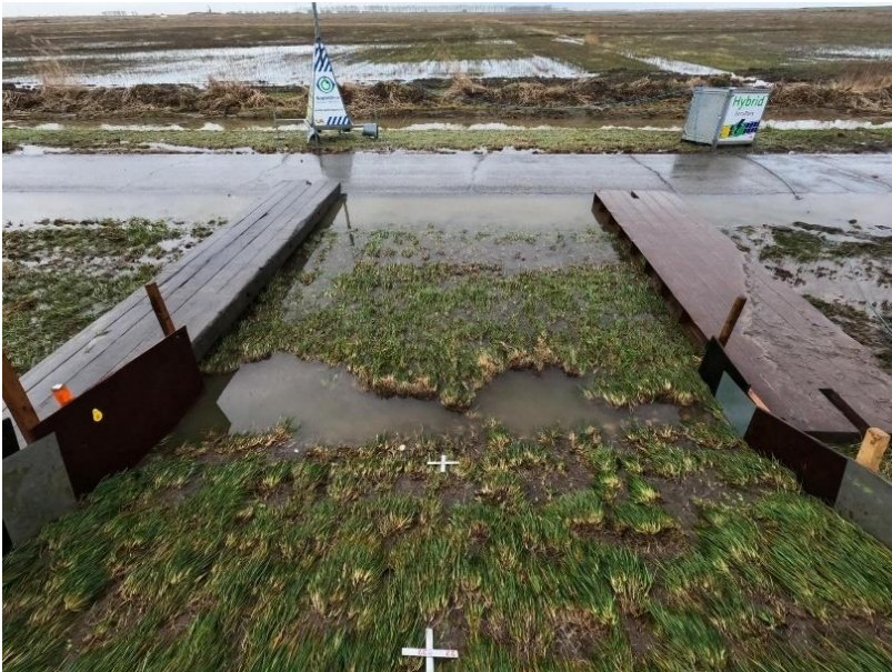
Figuur 31: Erosie in vak 23 na 4 stormuren met proef 1m190lsm
