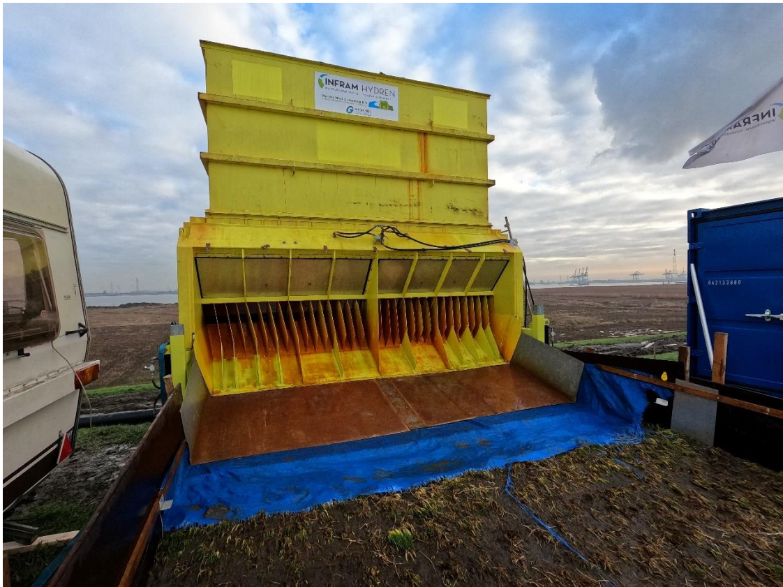
Figuur 3: De WOS op teststrook 0 binnen dijkvak VI
