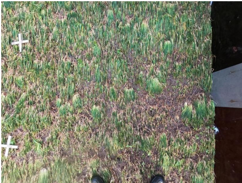
Figuur 28: Erosie van het gras in vak 12CD na 2 stormuren met proef 1m190lsm
