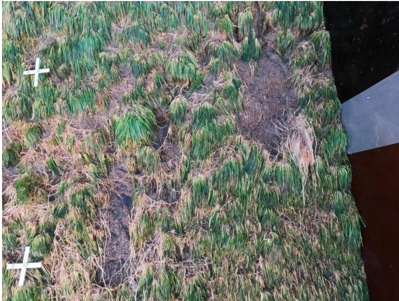
Figuur 22: Schadebeeld vakken 5-7CD na 2,5 uur storm met proef 1m190lsm
