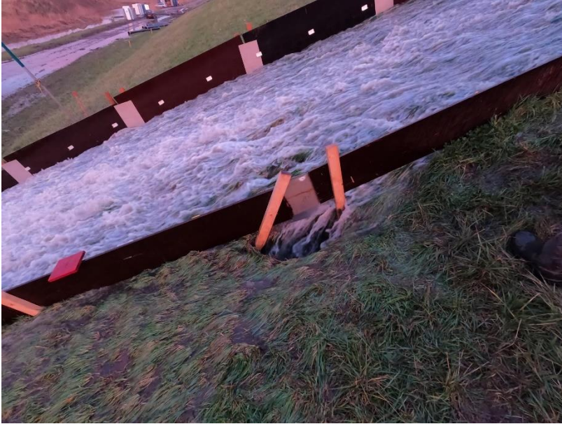
Figuur 14: Na circa 3 uur storm ontstond er in vak 14 een groot gat in de toplaag.
