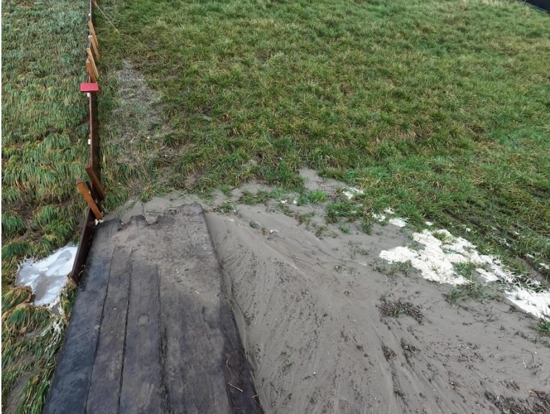
Figuur 12: Via een mologang buiten de teststrook ter hoogte van vak 19 werd tijdens het laatste stormuur van proef 1m190lsm het nodige zand geloosd
