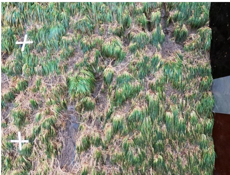
Figuur 21: Schadebeeld vak 6CD na 2 uur storm met proef 1m190lsm
