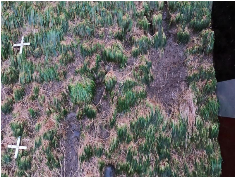
Figuur 23: Schadebeeld vakken 6CD na 3 uur storm met proef 1m190lsm
