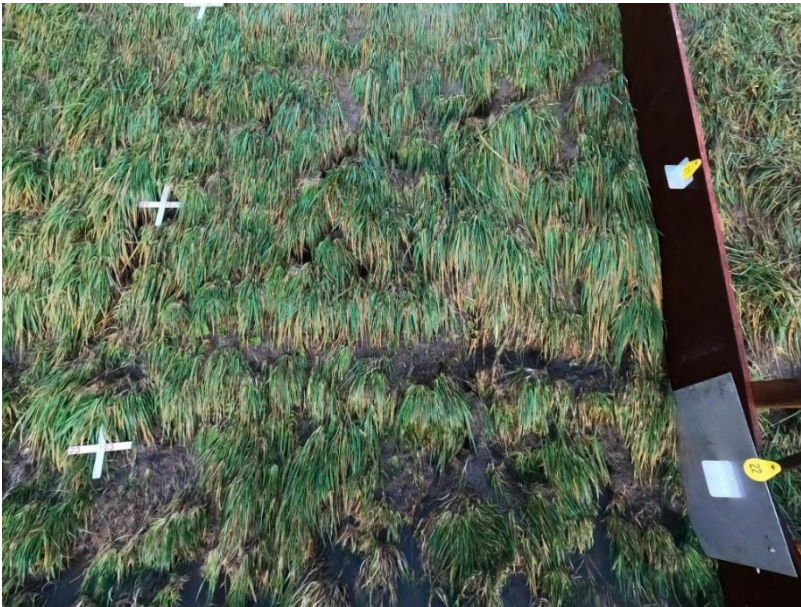
Figuur 9: Slijtage van mollengaten in vak 21-22CD na 1 stormuur van proef 0,5m60lsmov
