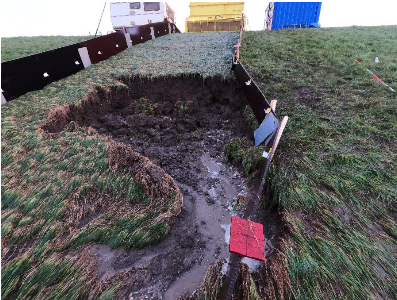
Figuur 15: Groot erosiegat na 3 uur en 45 minuten storm met proef 2m100lsm
