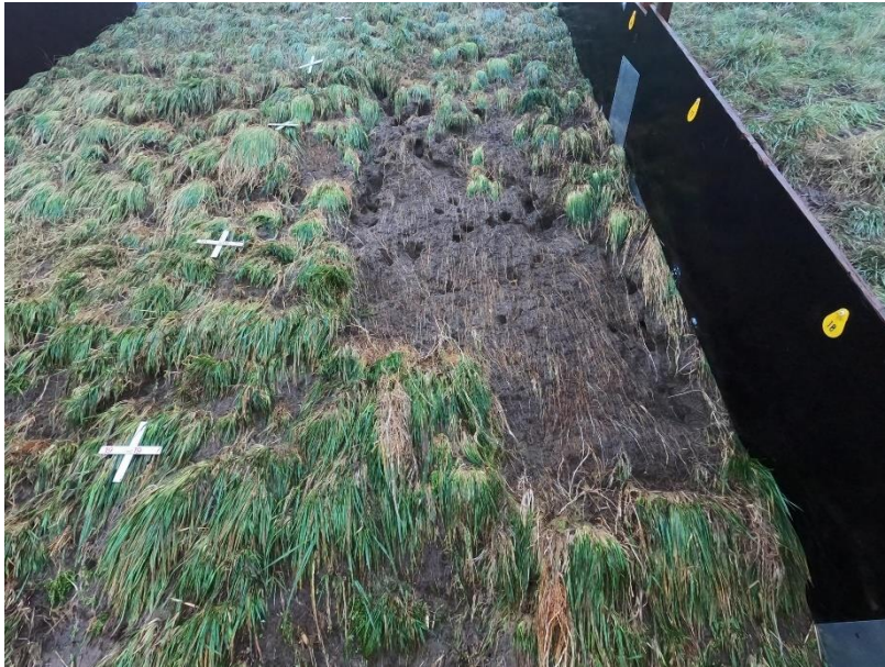
Figuur 16: Schadebeeld vakken 16-18CD aan het einde van proef 0,5m60lsmov
