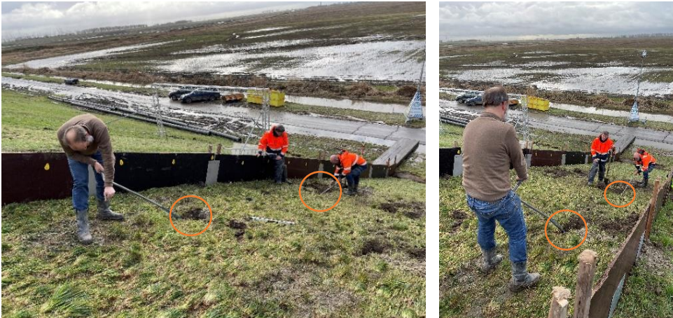
Figuur 32: Aanbrengen van schades met grondboor. Links in vakken 7CD en 13CD en rechts in vakken 7AB en 13AB.
