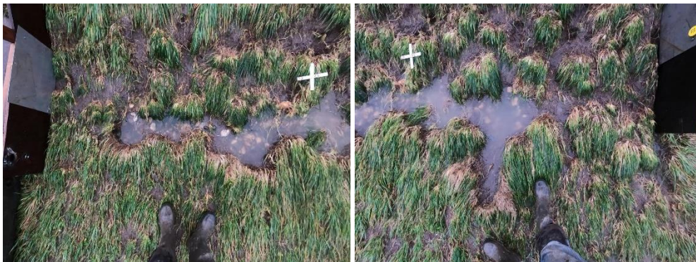
Figuur 25: Grindkoffer zichtbaar in vak 23AB (links) en 23CD (rechts) na 4 uur storm met proef 1m190lsm
