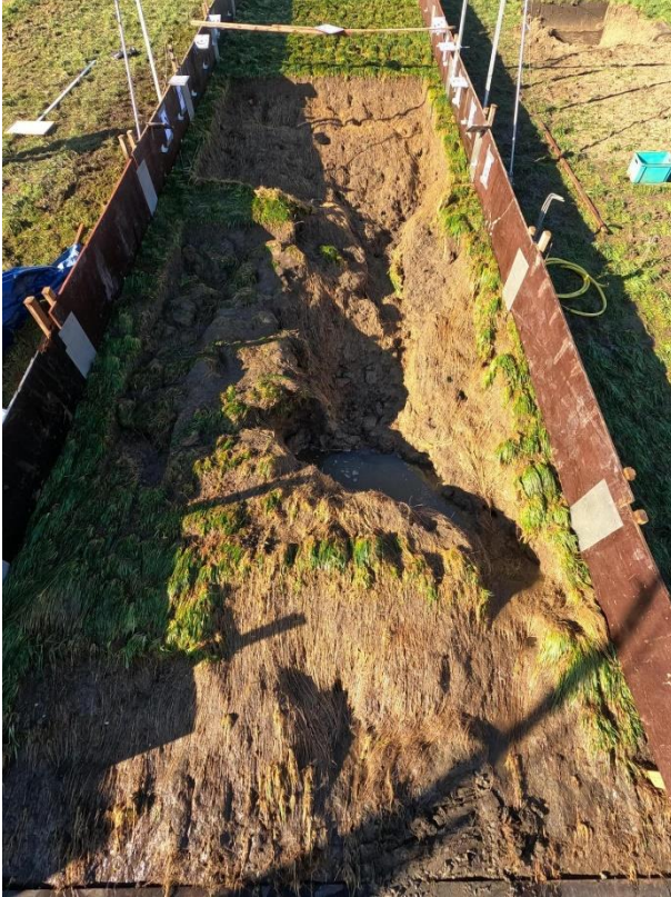
Figuur 43: Impressie van teststrook Kale klei 2 na proef 0,5m60lsm op de onderste sectie en zowel proef 1m50lsm als de hydraulische metingen op de middelste sectie.
