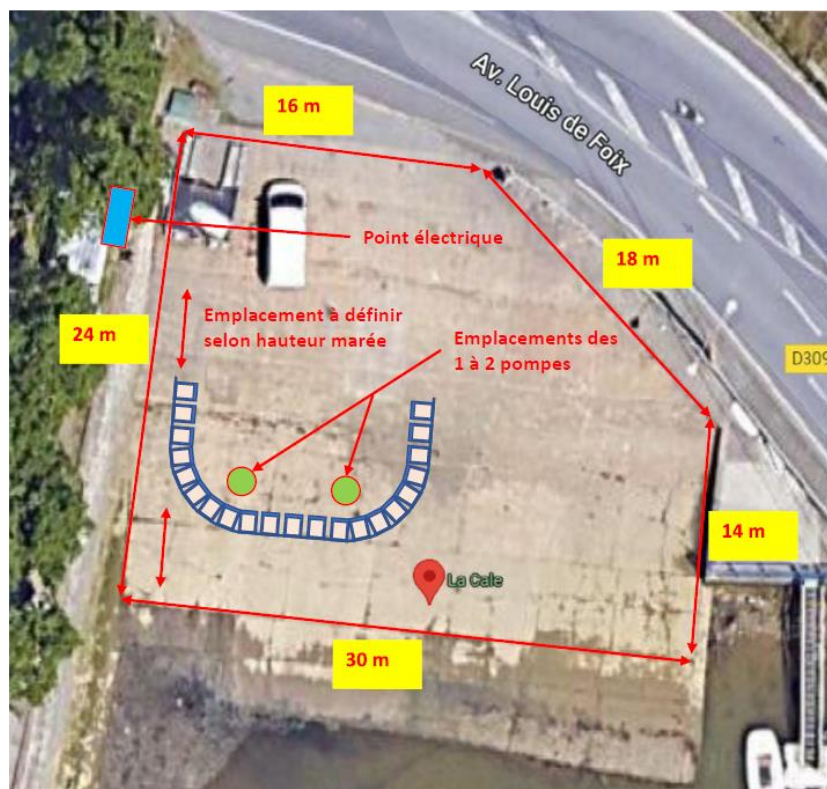
Fig. Configuration du site de test et positionnement de principe sur image satellite Google Earth (Cuirassier)
