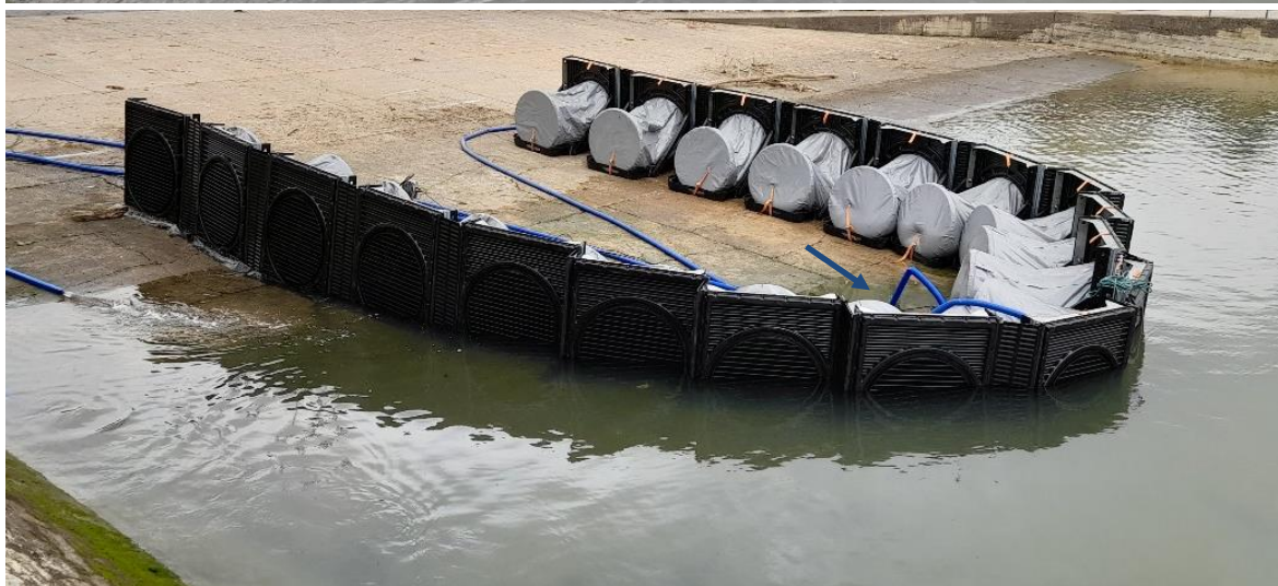
Fig. Essais J2 : atteinte de 85cm de charge amont et déplacement suite au batillage, fuite non compensée par 2 pompes, effet de la 3 e pompe
