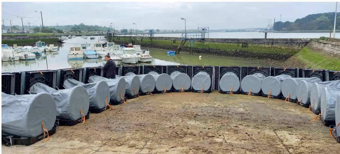
Fig. configuration générale retenue pour les tests, courbe maximale avec 2 éléments en tête
